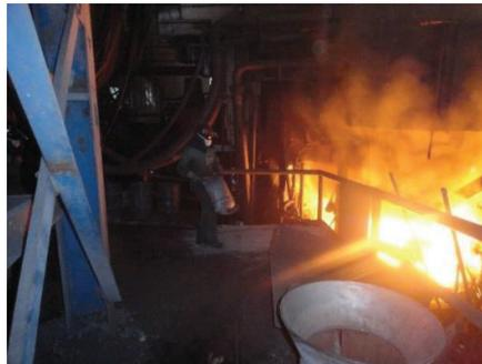
**Figura 2.2.** Implementación de la escoria sintética durante el vaciado
