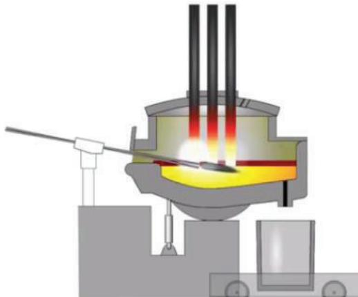
**Figura 1.4.** Esquema del Horno de Arco Eléctrico
