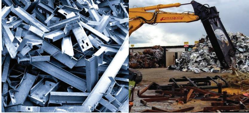
**Figura 1.2.** Chatarra semi pesada. Tipo troceada
