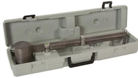
**Figura 1.1 Balanza de Fluido.**
