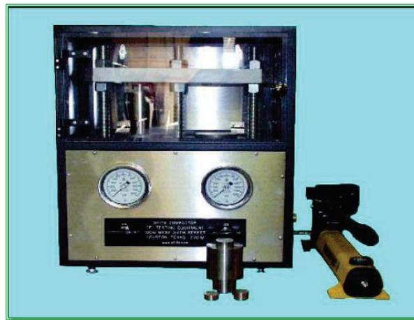
**Figura 3.12** Compactador para la Fabricación de las Pastillas.
