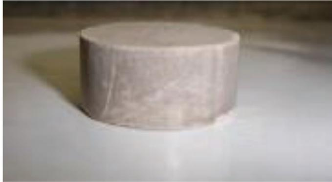
**Figura 1.21 Pastilla de Muestra del corte de Perforación.**
