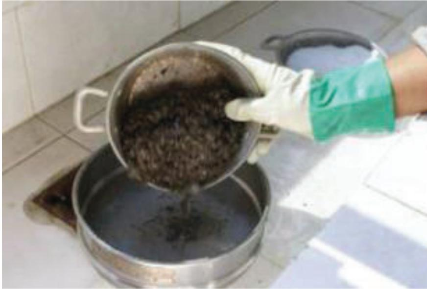
**Figura 1.18 Lavado de las Arcillas**
