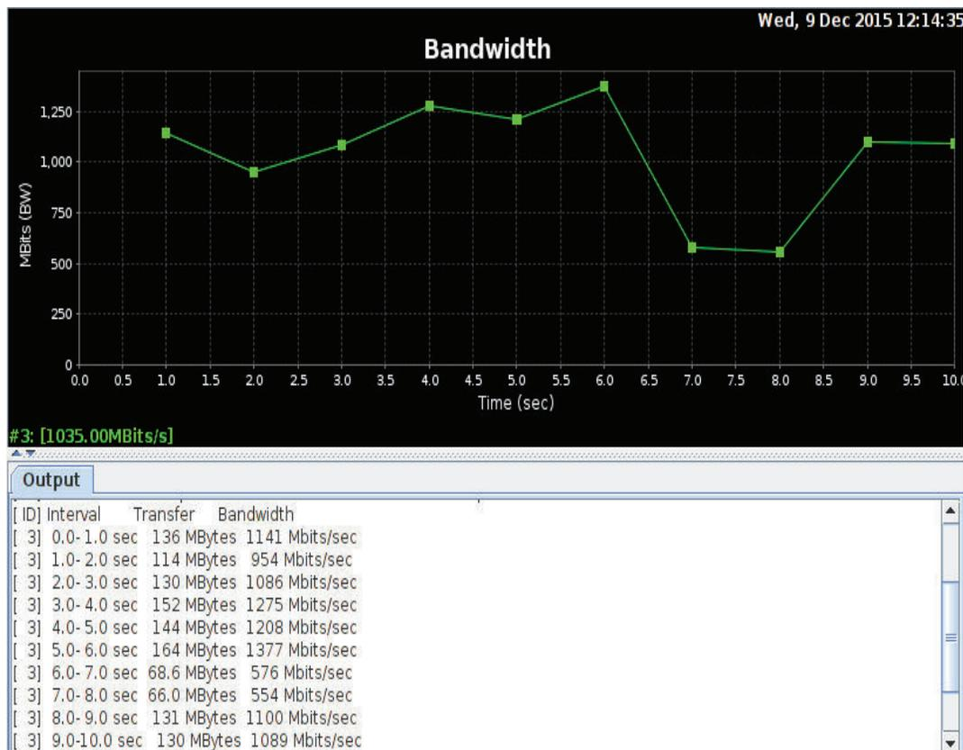
Figura 3.28 Resultados de mediciones de ancho de banda
