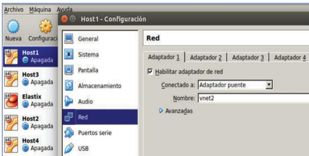
Figura 2.11 Configuración de la interfaz de red en Virtualbox
