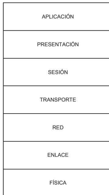
**Figura 1.2: Representación del modelo ISO-OSI**
