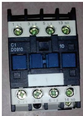
Fig.42. Contactor de fuerza
