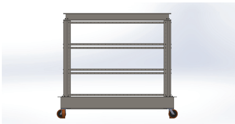
Figura 3.25: Vista frontal de la estructura del banco de pruebas (Fuente propia)
