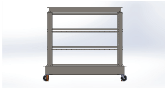
Figura 3.3: Estructura básica de sujeción de pared con ángulo y placas perforados (Fuente propia)
