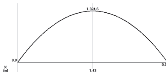
Figura 4.6: Diagrama del momento flector de la viga (Fuente propia)
