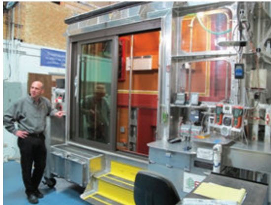
Figura 2.10: Cámara para ensayo de resistencia a la infiltración de agua (Wilson, 2014)
