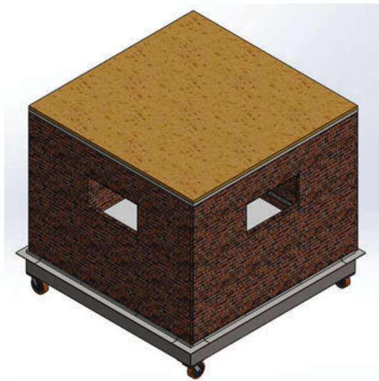
Figura 4.33: Colocación de los paneles del techo y del aislante (Fuente propia)
