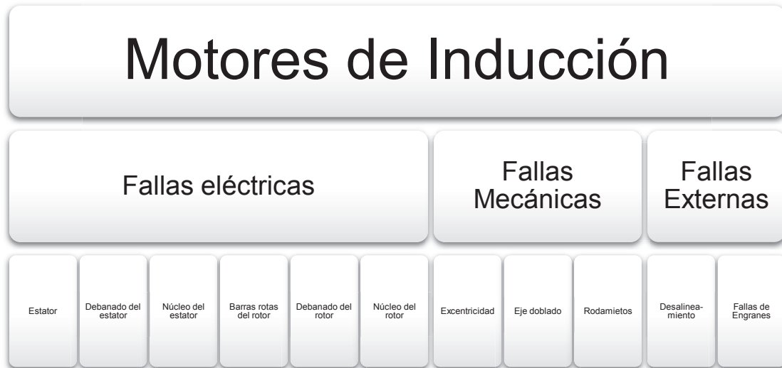
Figura 1.16 Clasificación de daños en motores de inducción (Basak & Tiwari, 2006).
