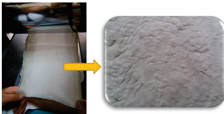
Figura 2.3. Desprendimiento de la lámina de pre-material del rodillo y acercamiento de la superficie del material
