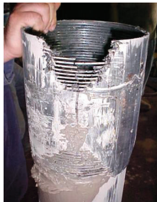
Figura 4.4 Desgaste y rotura de la conexión
