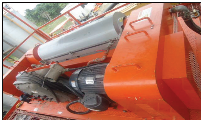
Figura 2.18 Esquema de la centrífuga decantadora
