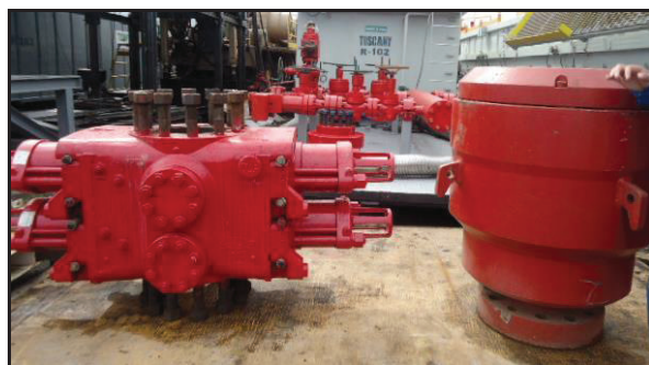
Figura 2.33 Preventoras de ariete, Manifold de choques, Preventora de anular (Hydrill)
