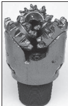
Figura 2.28 Broca Tricónica de carburo de tungsteno
