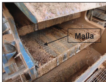
Figura 2.16 Zaranda en funcionamiento
