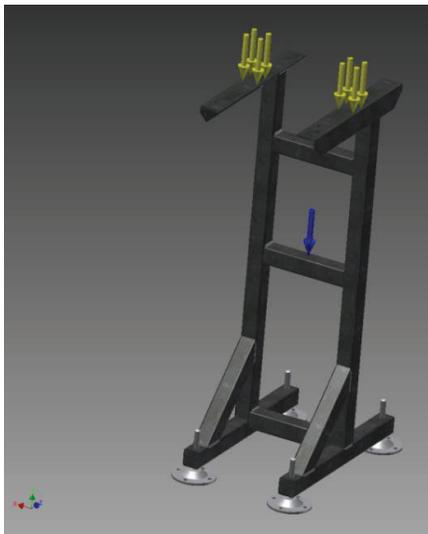
**Figura 4-37:** Fuerzas aplicadas en la estructura soporte
