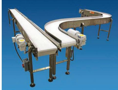
**Figura 2-8:** Avance por banda transportadora
