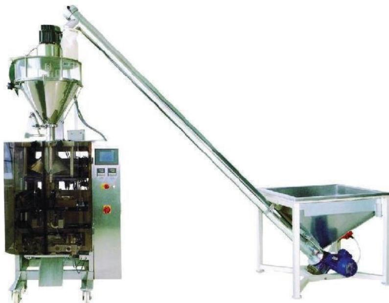
**Figura 2-4:** Máquina dosificadora con sistema de alimentación por elevador.
