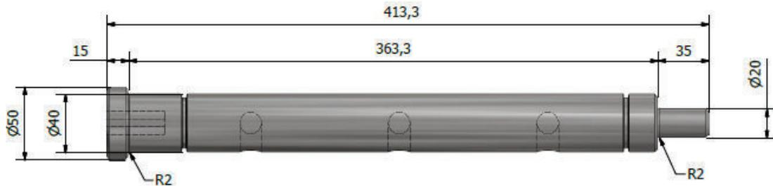
**Figura 4-13:** Medidas generales del eje dosificador
