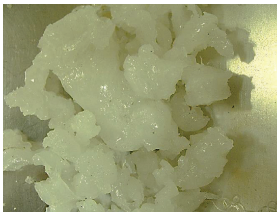
Figura 3.9 Mezcla sólida de PEBD/prodegradante al 5% en peso de aditivo a 4 minutos y 150 °C realizada en la cámara de mezcla HAAKE
