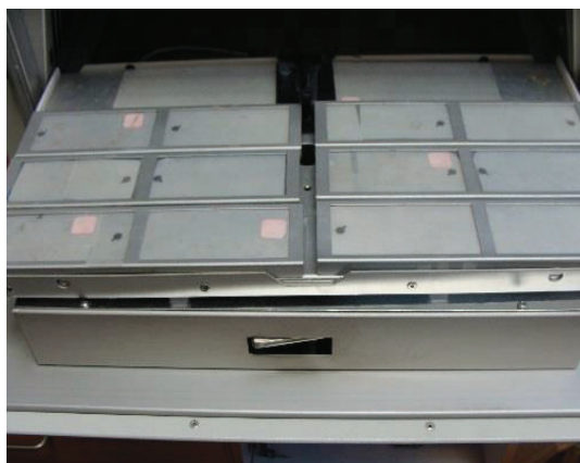
Figura 2.6 Disposición de las placas de PEBD/prodegradante dentro de la cámara de arco xenón
