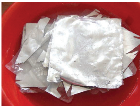
Figura 3.11 Placas con aluminio de la formulación PEBD/prodegradante sumergidas en una solución de NaOH al 5%
