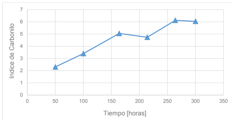
Figura 3.32 Crecimiento del índice de carbonilo con base a área total con respecto al tiempo de exposición de la placa PEBD/prodegradante a luz UV para el repetición 5
