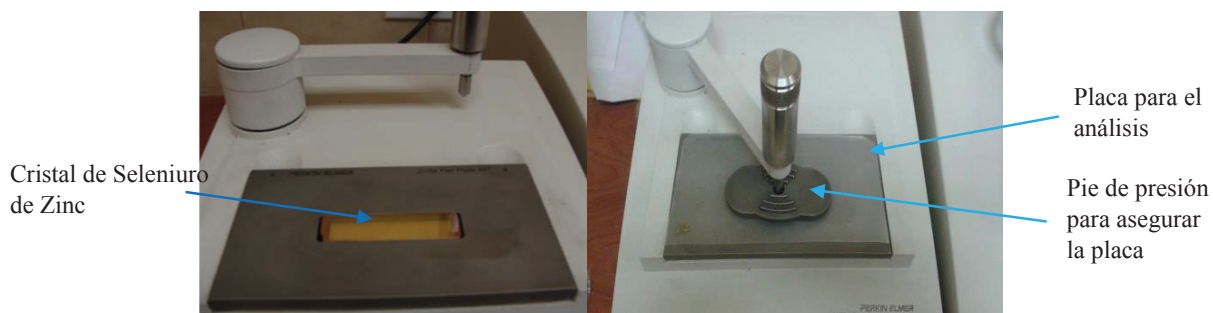
Figura 2.4 Sistema de análisis FTIR por HATR para placas de PEBD/prodegradante expuestas durante un ciclo
