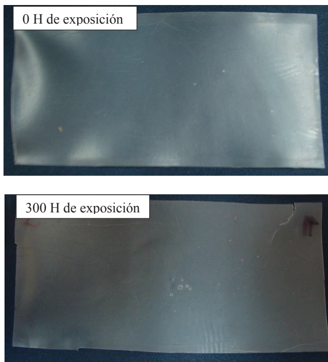
Figura 3.24 Placas de PEBD/prodegradante a 0 y 300 horas de exposición en la cámara UV
