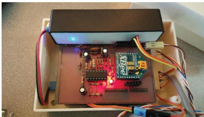
**Figura B.10.** Funcionamiento del Módulo de Control Remoto
