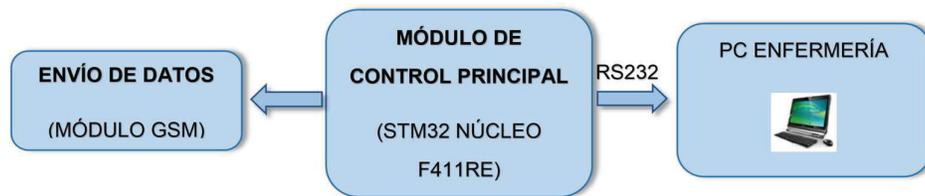
**Figura 2.2.** Diagrama de bloques del Módulo de Control Principal
