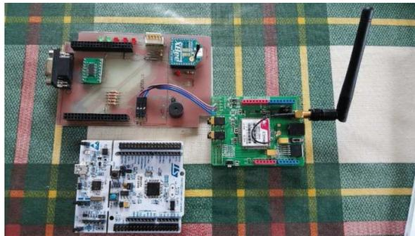
**Figura 4.1.** Placas que conforman el Módulo de Control Principal
