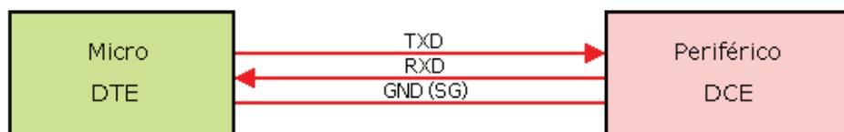
**Figura 2.26.** Requerimientos mínimos para conexión full dúplex
