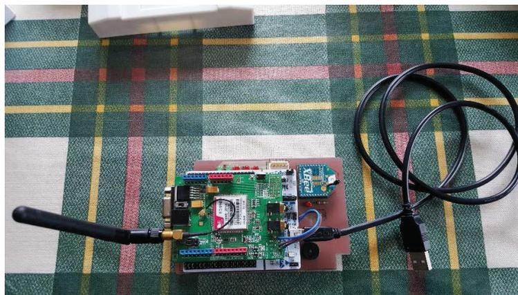
**Figura B.3.** Módulo de Control Principal con el cable USB que se conecta a la PC
