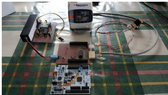
**Figura 4.2.** Placas que conforman el Módulo de Control Remoto
