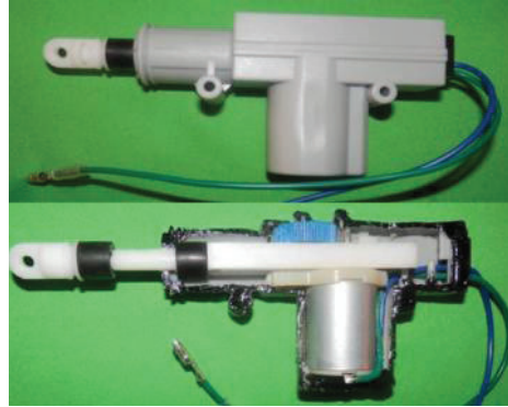
Figura 1.17 Propulsor de puerta.
