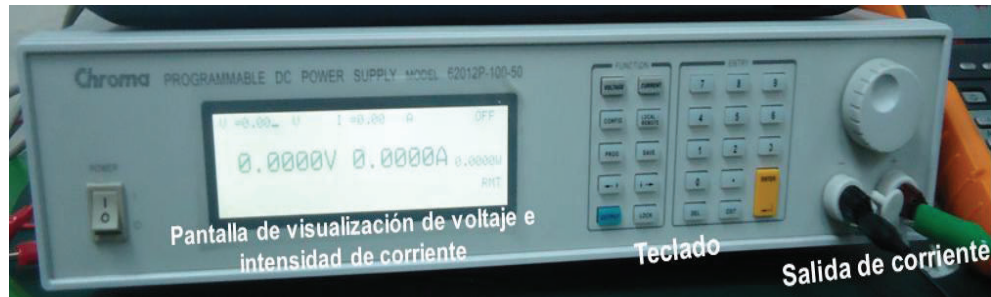
Figura 3.2 Equipo simulador de condiciones eléctricas.
