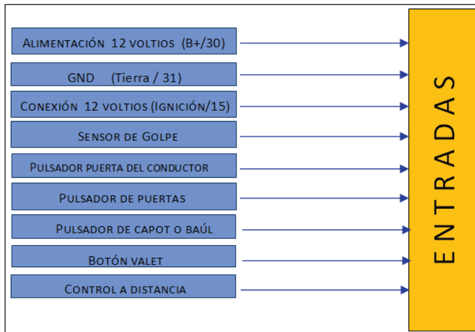
Figura 2.1 Señales de entrada al módulo.
