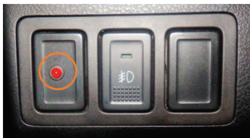
Figura 1.12 Led indicador de alarma. Fuente: Lema J. Pancha J., (2016)
