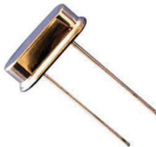
Figura 2.10 Oscilador de cristal.
