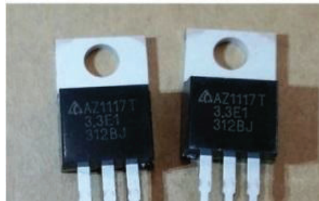
Figura 2.8 Regulador de tensión LM1117-3.
