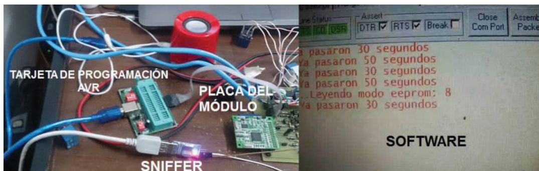
Figura 2.20 Sniffer, tarjeta programadora de AVR y software XCTU.
