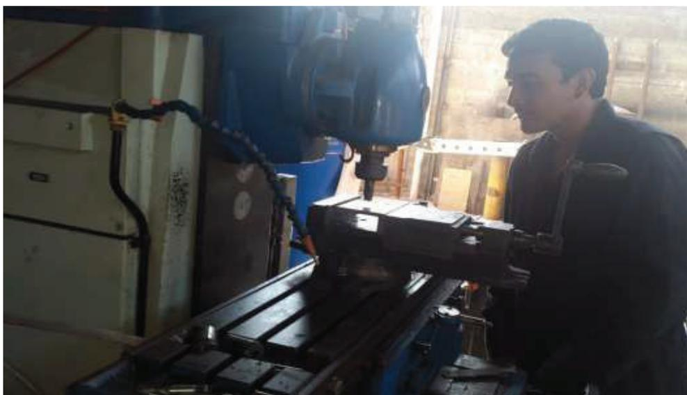
**Fig. 130. Operación de fresado de placas porta ruedas**
