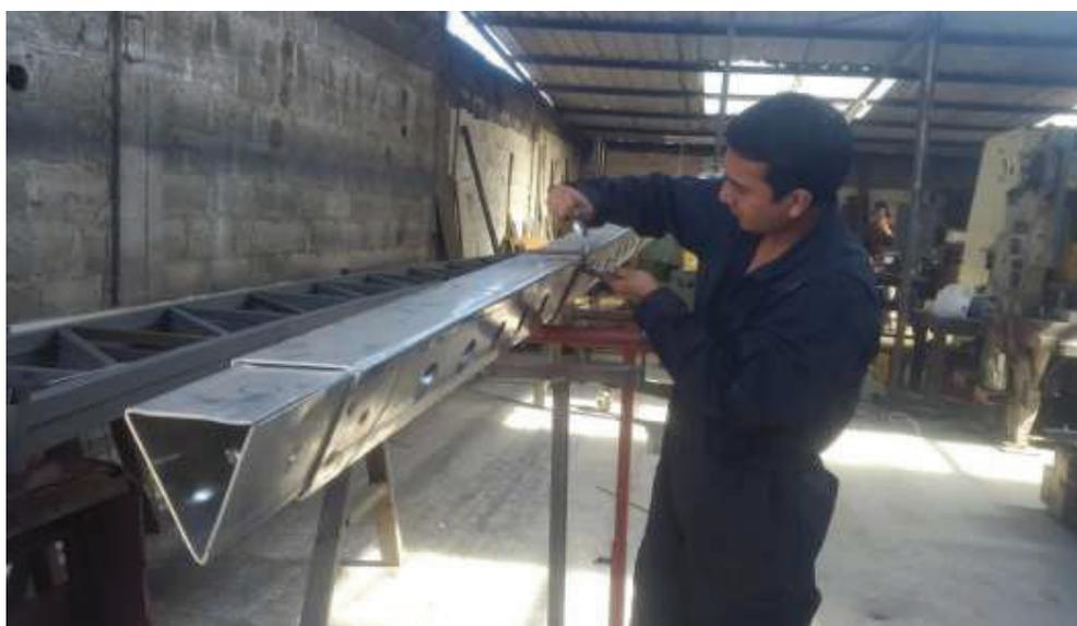
**Fig. 131. Ensamble de las secciones del brazo telescópico**
