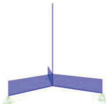
Fig. 91. Diagrama de cortante para cada pata del trípode
