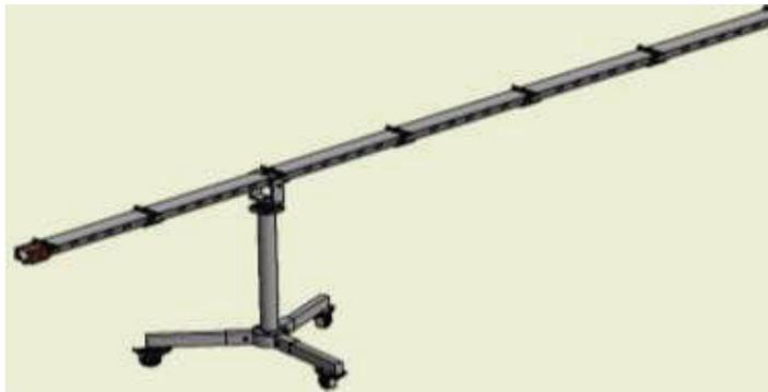
Fig. 73. Solución ganadora sistema telescópico
