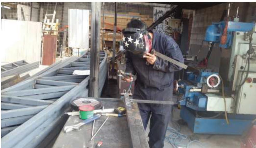
Fig. 128. Operación de soldadura de barra de soporte de cables
