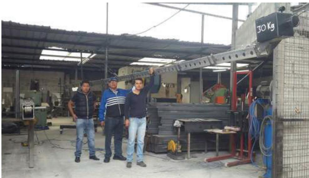
**Fig. 134. Pruebas de campo del funcionamiento con carga máxima**
