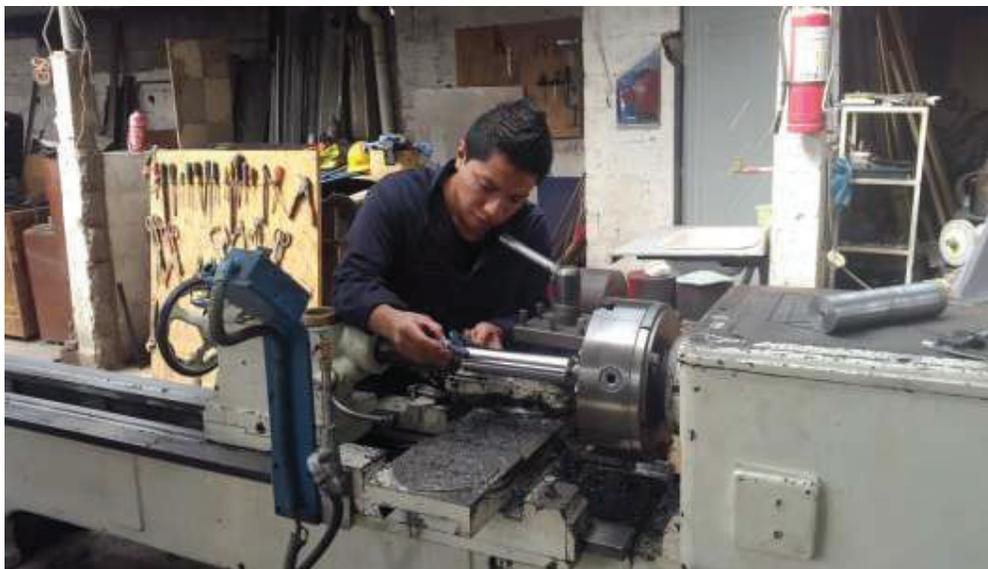
**Fig. 129. Operación de torneado del eje de giro paralelo al plano vertical**
