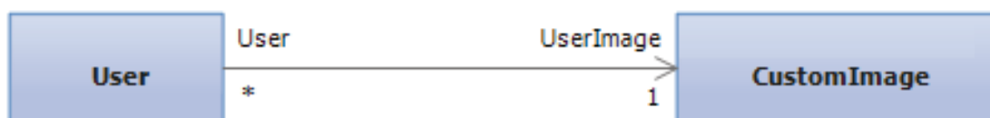
Figura 3.3: Ejemplo de lectura del diagrama de clases de la aplicación web
