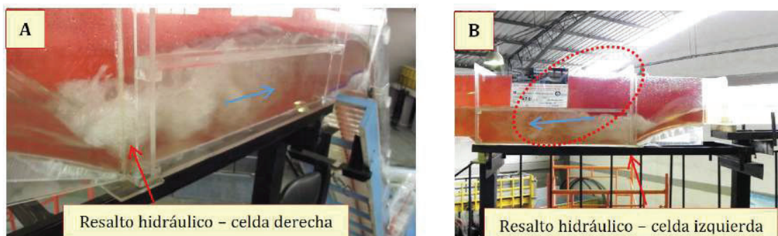
FIGURA 5.18: PRUEBA 5. VISTA LATERAL DERECHA (A) E IZQUIERDA (B) DEL CUENCO DISIPADOR 1. Q_{TOTALPROTOTIPO} = 101.78 \text{ m}^3/\text{s}
