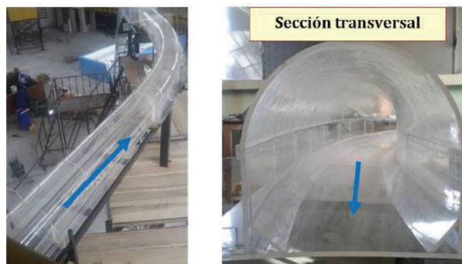
FIGURA 4.5: TRAMO DE APROXIMACIÓN CONSTRUIDO EN ACRÍLICO
