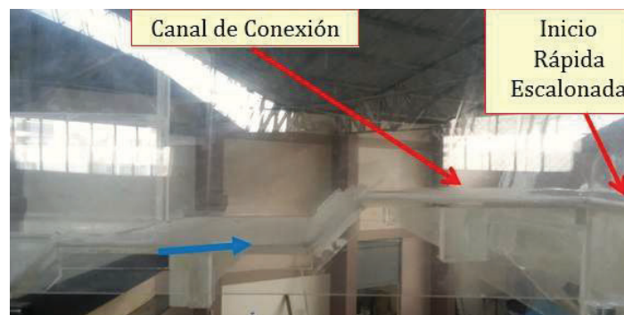
FIGURA 4.8: CANAL DE CONEXIÓN CONSTRUIDO EN ACRÍLICO
