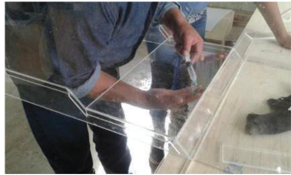
Construcción de base, paredes y gradas del primer cuenco disipador.
