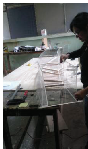
Construcción de base y parte recta de las paredes de la sección tipo baúl del túnel de aproximación
