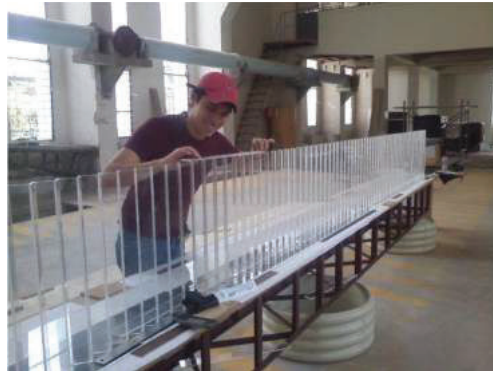
Construcción de base y parte recta de las paredes de la sección tipo baúl del túnel de aproximación
