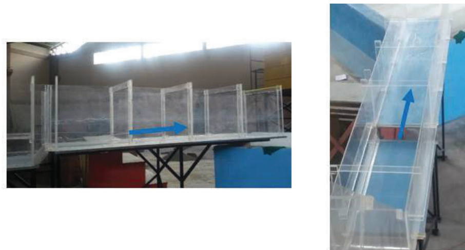
FIGURA 4.11: CANAL DE CONEXIÓN HACIA LA SEGUNDA RÁPIDA CONSTRUIDO EN ACRÍLICO
