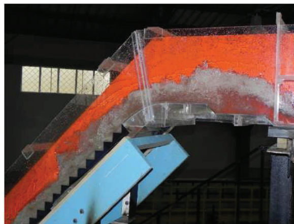
FIGURA 7.1: VISTA LATERAL IZQUIERDA DE LA RÁPIDA ESCALONADA. Q_{TOTALPROTOTIPO} = 149.07 \text{ m}^3/\text{s} Q_{CELDA IZQUIERDA} = 72.42 \text{ m}^3/\text{s}
