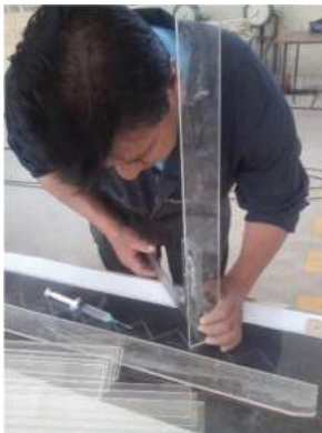
Construcción de base y parte recta de las paredes de la sección tipo baúl del túnel de aproximación
