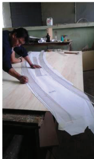
Construcción de base y parte recta de las paredes de la sección tipo baúl del túnel de aproximación
