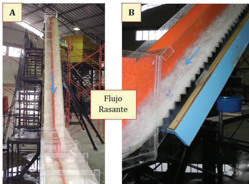
FIGURA 5.23: PRUEBA 6. VISTA FRONTAL (A) Y LATERAL IZQUIERDA (B) DE RÁPIDA ESCALONADA. Q_{TOTALPROTOTIPO} = 149.07 \text{ m}^3/\text{s}
