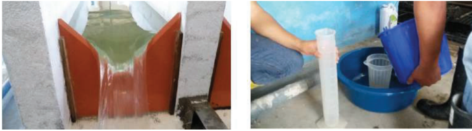
FIGURA 4.22: AFORO VOLUMÉTRICO PARA EL VERTEDERO TRIANGULAR
