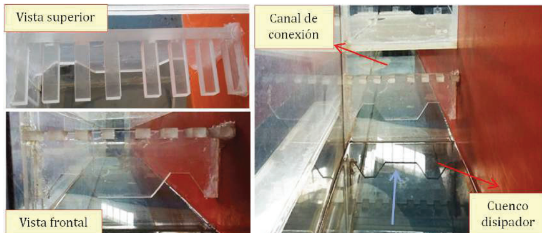
FIGURA 6.8: IMPACTADOR EN FORMA DE “L” INVERTIDA FABRICADO EN ACRÍLICO Y SU IMPLANTACIÓN EN EL CUENCO DE DISIPACIÓN AL PIE DE LA RÁPIDA ESCALONADA EN EL MODELO FÍSICO
