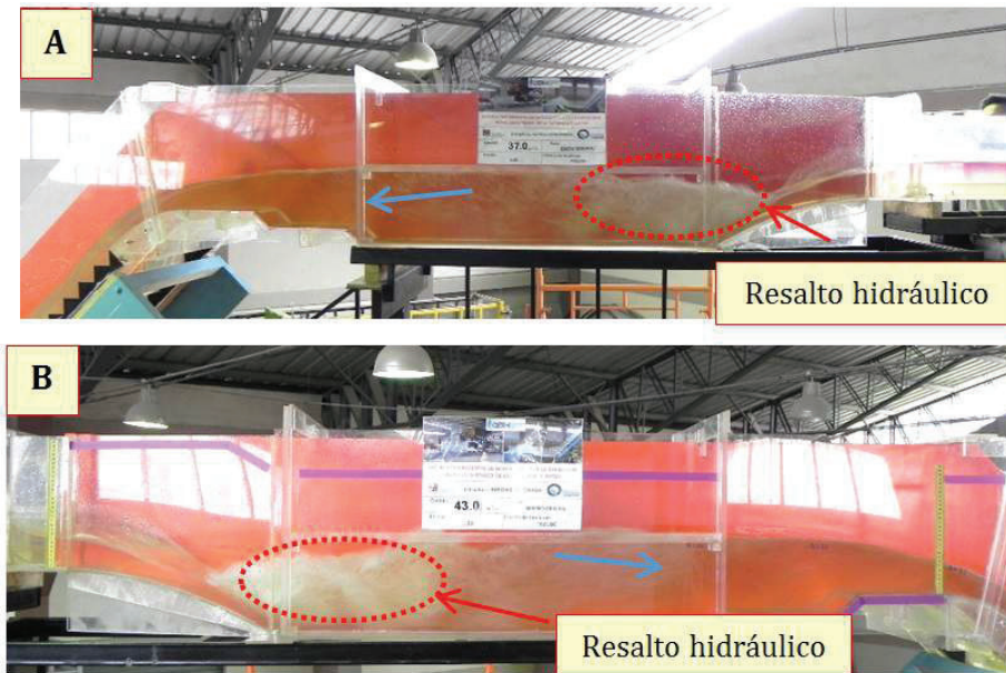
FIGURA 5.14: PRUEBA 4. VISTA LATERAL IZQUIERDA (A) Y DERECHA (B) DEL CUENCO DISIPADOR 1. Q_{TOTALPROTOTIPO} = 80.19 \text{ m}^3/\text{s}
