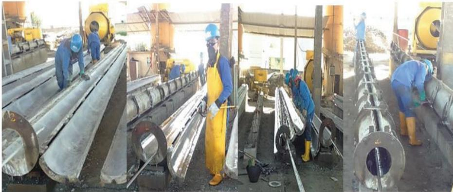
Fotografía: 1-9 Armado de moldes
