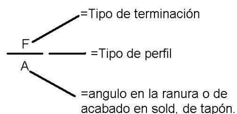
Figura 1.10 Referencia del símbolo de soldadura
