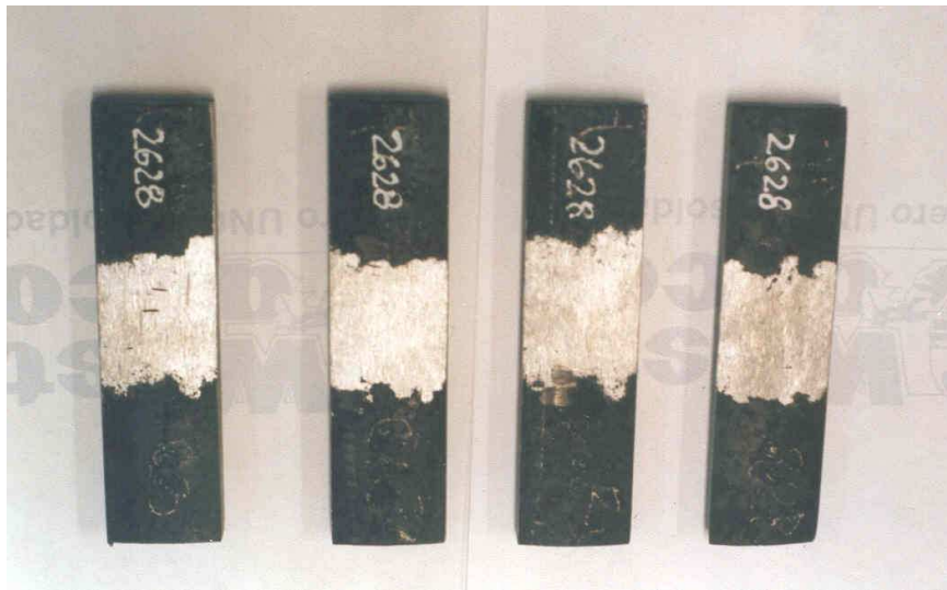
Figura 1.37 Probetas ASME para ensayo de dobleza
