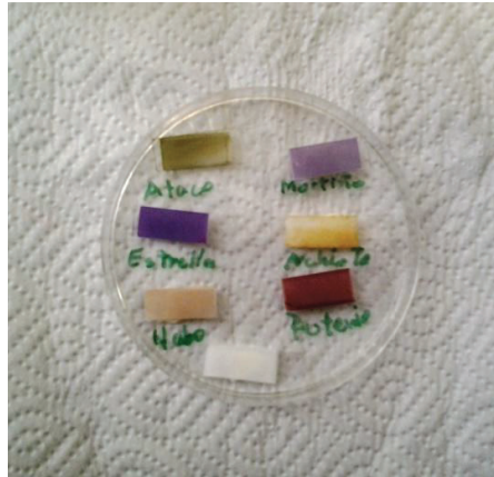
Figura 3-16 Muestras de \text{TiO}_2 pigmentadas con diferentes tintes, utilizadas para obtener espectros de absorción.
