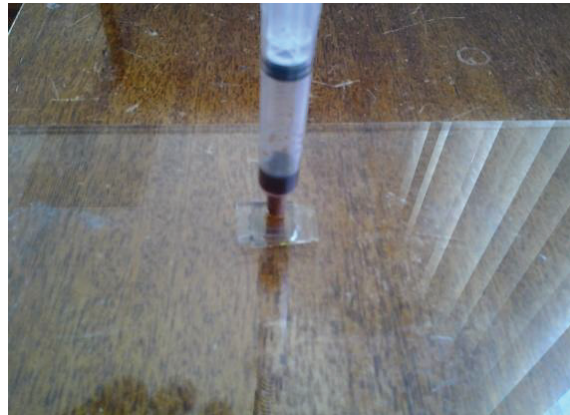
Figura 3-11 Jeringa con ventosa de caucho en la parte inferior que permite el ingreso de electrolito líquido en la celda solar.
