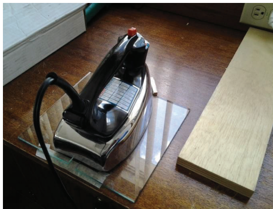
Figura 3-10 Plancha colocada sobre electrodos que se ubican en el eje del centro de gravedad, permitiendo tener un buen sellado de las celdas.
