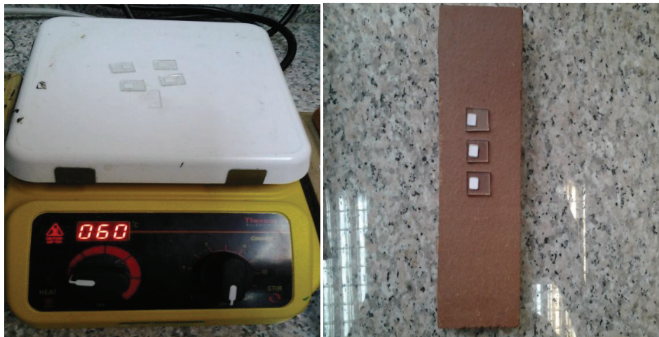
Figura 3-4 Izquierda: Plato caliente de plataforma cerámica en la que se sinterizó el \text{TiO}_2 . Derecha: TCO con \text{TiO}_2 ya sinterizado.
