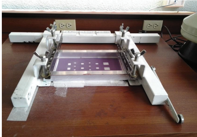
Figura 3-2 Dispositivo casero adaptado para realizar deposición de pasta de \text{TiO}_2 por serigrafía.
