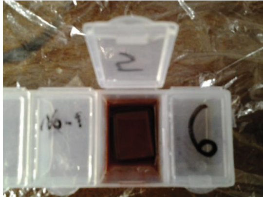
Figura 3-5 Pigmentación del \text{TiO}_2 con tinte Ruthenizer 535-bisTBA [N719], Solaronix
