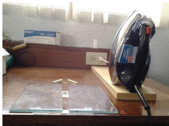
Figura 3-9 Plancha de ropa utilizada como dispositivo para sellar las celdas DSSCs
