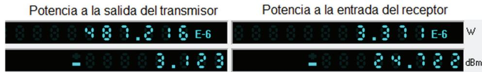
**Figura 4.15** Medidores de potencia óptica
