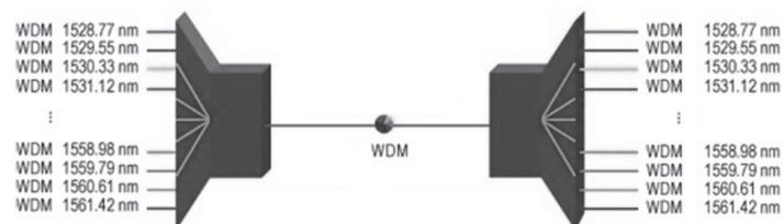
**Figura 3.38 Diagrama de un sistema de transmisión con WDM [21]**
