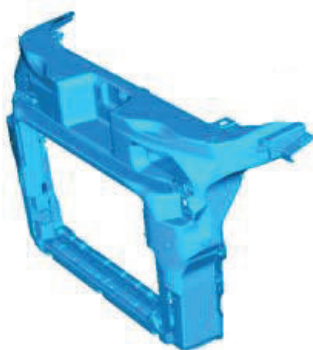
Figura 2.19. Travesaño delantero Fuente: PTS. Ford, 501-02 Front end body panels
