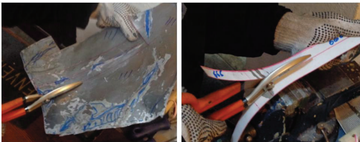
Figura 4.2. Corte de probeta ensayo de tracción
