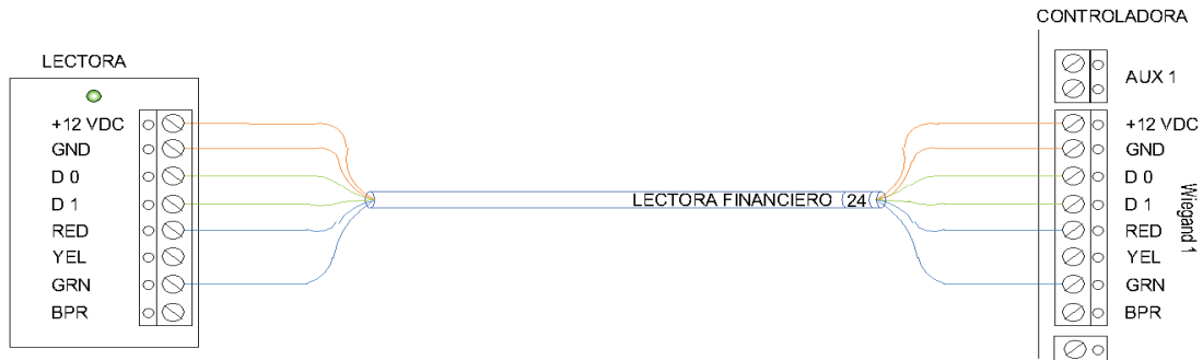
Figura 2.8 Conexión LECTORA HID.
