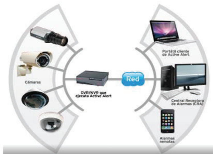
Figura 1. 3 Esquema general sistema CCTV. [2]
