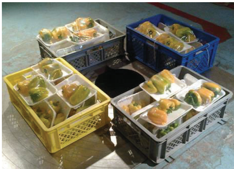
Figura 2.2. Arreglo de kavetas con bandejas de pimiento para ser irradiadas
