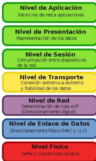
Figura 1.10 Capas del modelo de referencia OSI [6]
