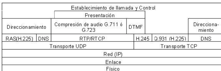
Figura 1.24 Control de Transmisión en Protocolo H.323 [17]
