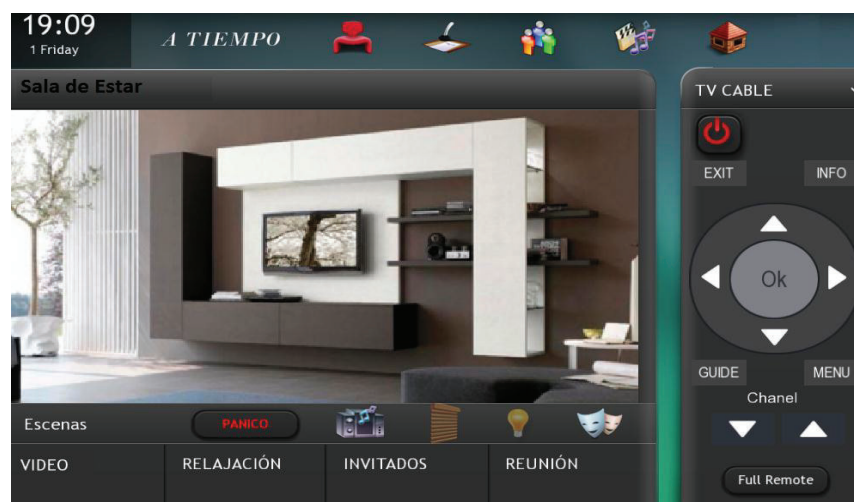
Figura 3 31: HMI control de Sala de Estar en el 2do piso
