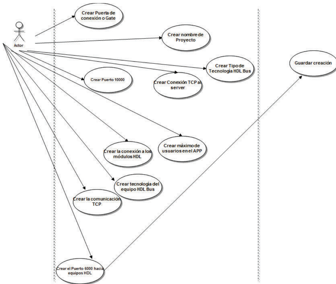
Figura 3.1: Diagrama de funcionamiento de IRIDIUM GATE
