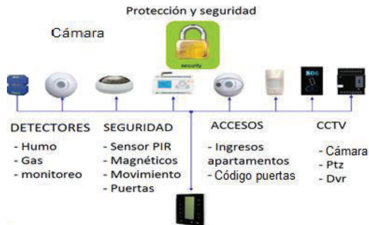
Figura 1.33: Solución de seguridad, protección y accesos
