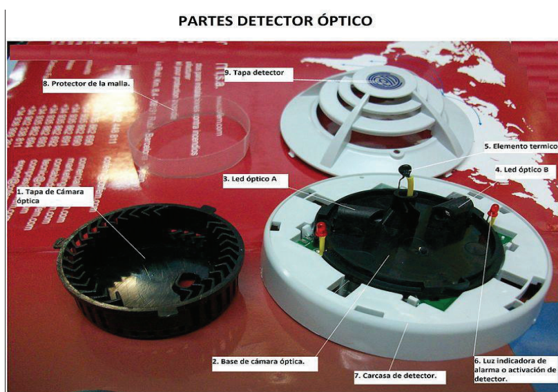
Figura 2.19: Partes del detector óptico/fotoeléctrico
