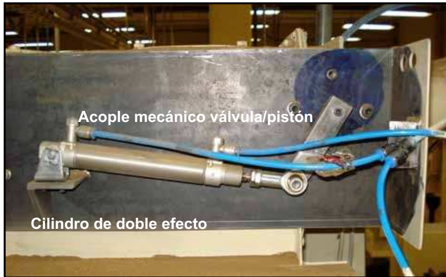
Fig. 2.2 Cilindro de doble efecto acoplado mecánicamente a la válvula de circulación de flujo.
