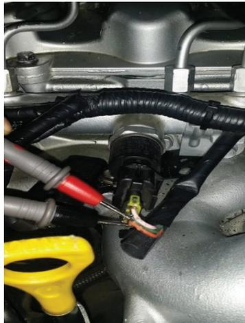
**Figura 2.25** - Conexión de los puntales del multímetro en el RPS
