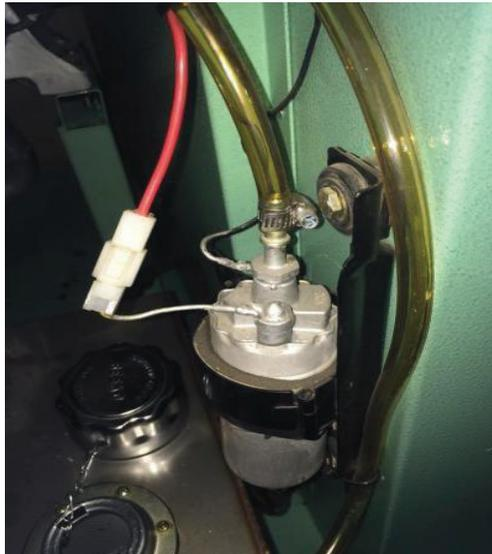
**Figura 2.64** - Ubicación de la bomba eléctrica de alimentación de combustible.
