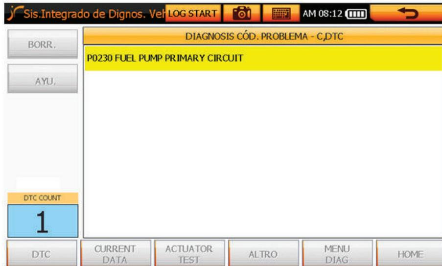
Figura 2.70 - Código de falla de la bomba de alimentación de combustible en el scanner
