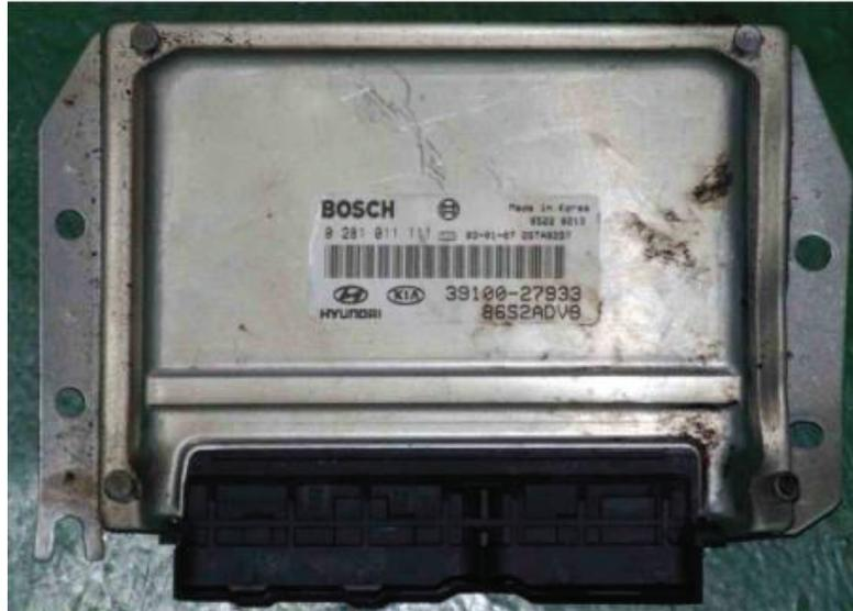
**Figura 1.2** - Unidad de Control del Motor Santa Fe CRDI 2.0 (ECM)
