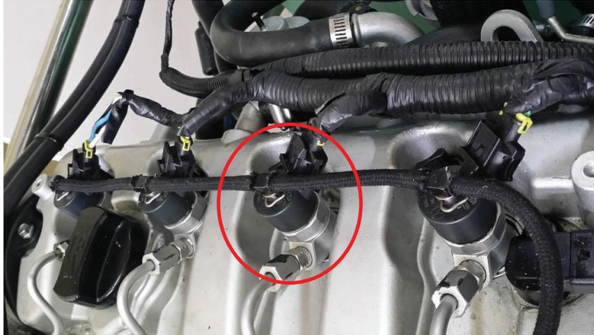
**Figura 2.58** - Disposición de los Inyectores de Combustible CRDi en el Motor Hyundai Santa Fe 2.0
