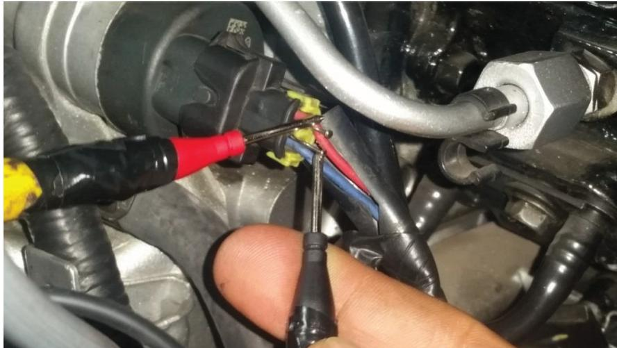
**Figura 2.54** - Conector del Regulador de Presión del Riel
