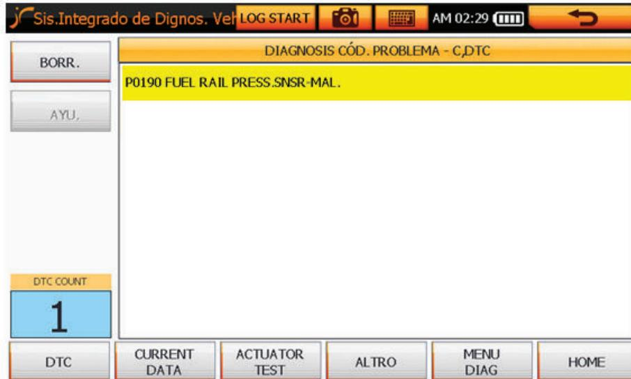
Figura 2.37 - Código de falla (DTC) generado por el RPS
