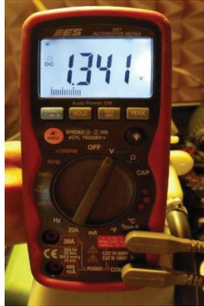
Figura 2.26 - Voltaje de señal del RPS obtenido en ralentí (850 rpm)
