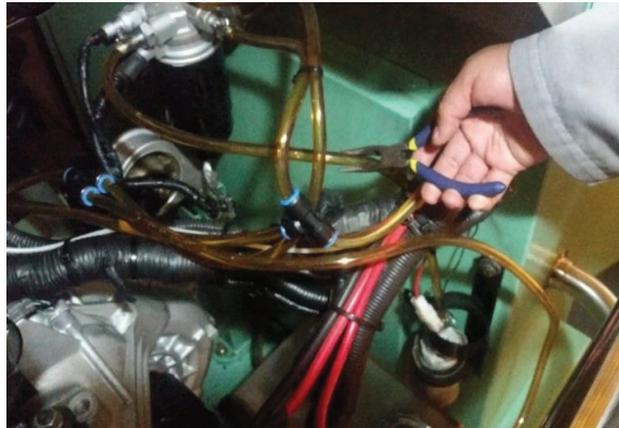
Figura 2.15 - Forma de obturar la tubería de combustible con una pinza.
