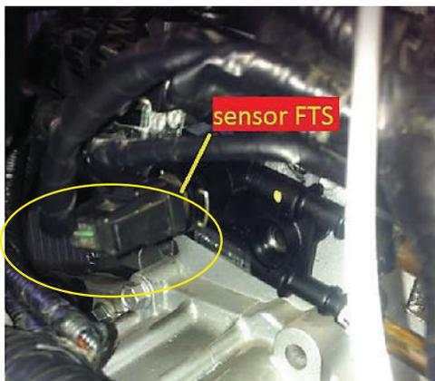
Figura 2.38 - Ubicación del Sensor de Temperatura del combustible
