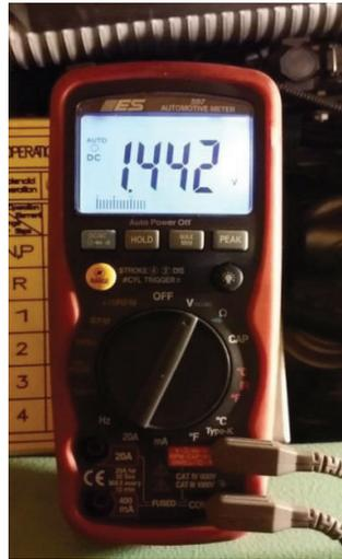
Figura 2.32 - Voltaje de salida del RPS medido por el multímetro variando el Potenciómetro.
