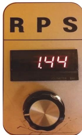
**Figura 2.31** - Potenciómetro utilizado para la variación de la señal de salida del RPS.
