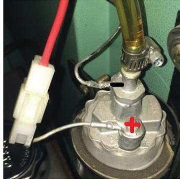
**Figura 2.66** - Cables de alimentación y masa de la bomba eléctrica de combustible
