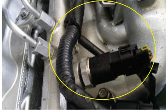
**Figura 2.22** - Ubicación del Sensor RPS en la riel
