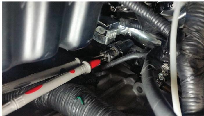
**Figura 2.41** - Medición de la resistencia del sensor de temperatura de combustible
