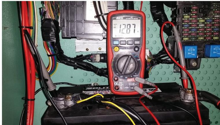
Figura 2.10 - Medición de la tensión de la batería con el multímetro.
