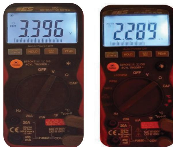
**Figura 2.42** - Valores de voltaje y resistencia del FTS a 20°C
