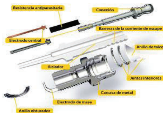
FIGURA 1.14. Componentes de la bujía. 24
