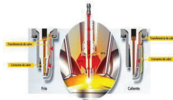
FIGURA 1.13. Disipación de calor y flujo térmico.
