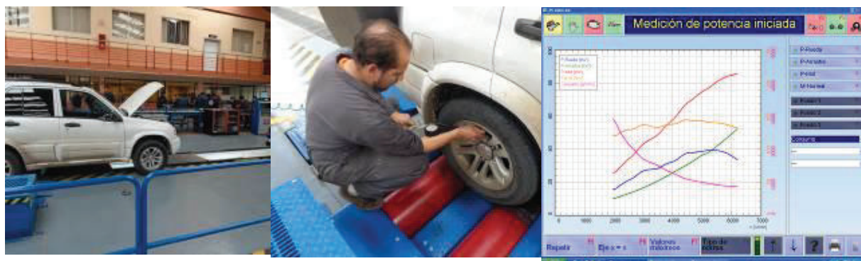
FIGURA 3.11. Equipos y procedimiento - Prueba en banco de potencia.
