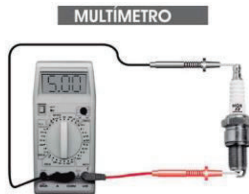
FIGURA 1.18. Medición pasaje de corriente. 27
