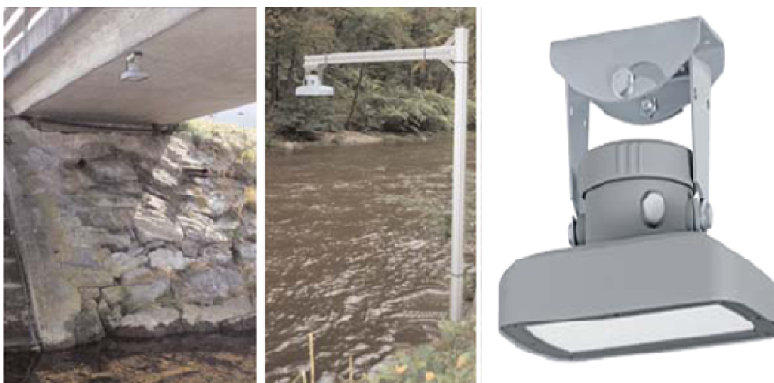
Figura 1.4. Sensor por radar RLS OTT colocado en sitio
