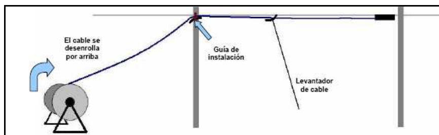
Gráfico 4.27. Extracción correcta del cable coaxial
