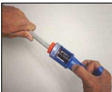
Gráfico 4.29. Preparadora de cable y cable coaxial sin chaqueta
