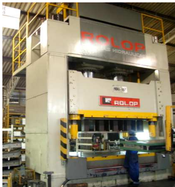
Fig. 1.13 Prensa Hidráulica de doble pistón, de 1000 tn.
