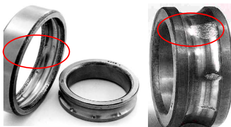
Fig. 1.3 Daños en los caminos de rodadura
