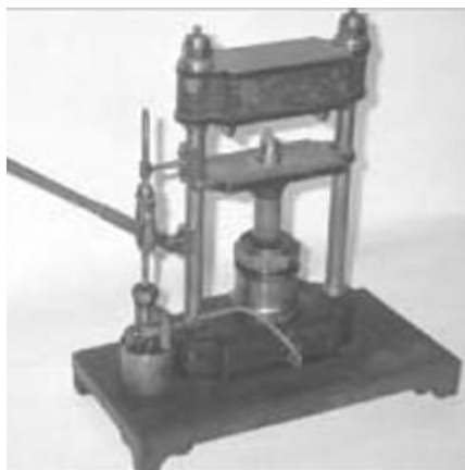
Fig. 1.10 Prensa de fricción para estampar de principios del siglo XX.
