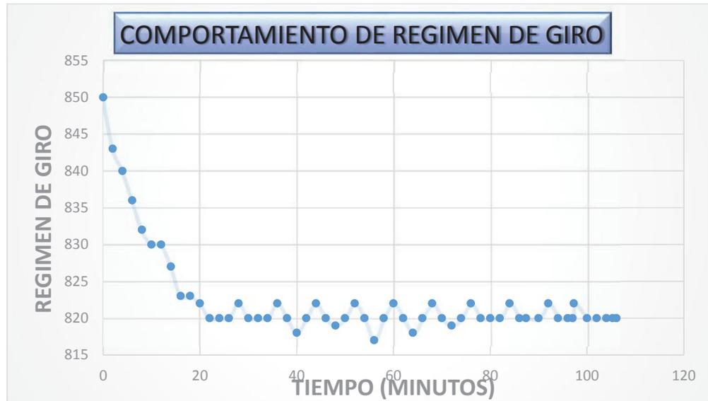
Figura 2. 24 Comportamiento del régimen de giro del motor.
