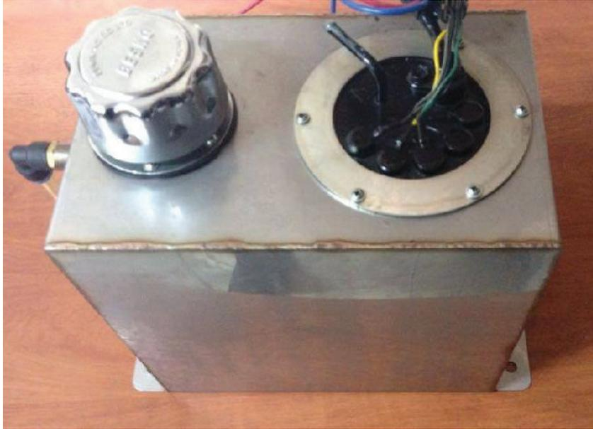
Figura 2. 11 Depósito auxiliar de combustible.
