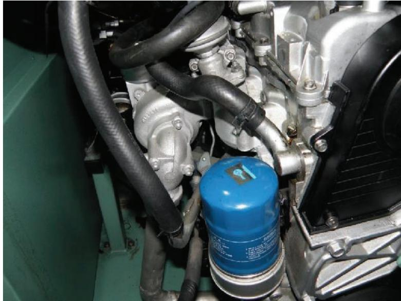
Figura 2. 3 Zona de análisis (Colector de escape y turbo compresor).
