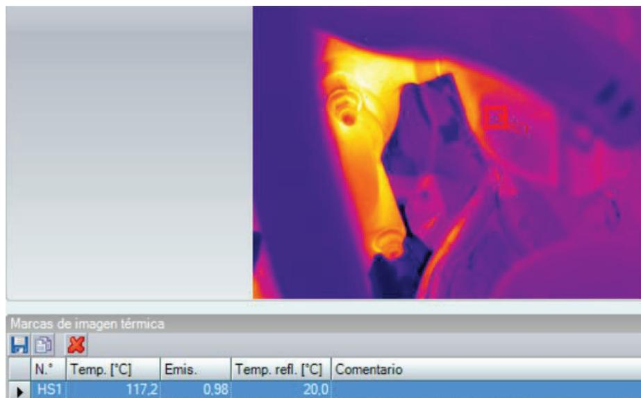
Figura 2. 18 Punto de análisis comparativo para determinar la emisividad en la firma termográfica.
