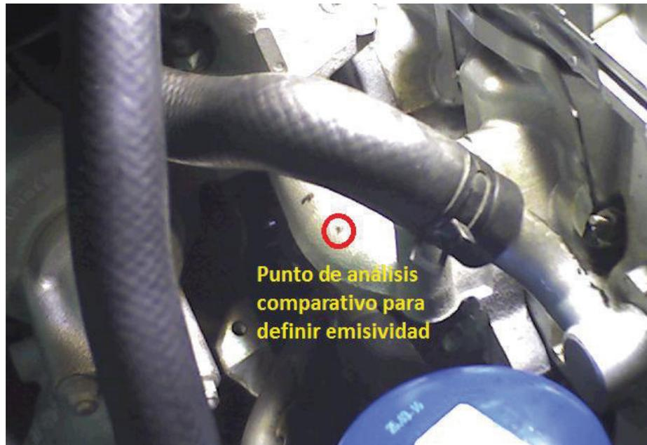
Figura 2. 17 Punto de análisis comparativo para determinar la emisividad de la cámara termográfica.
