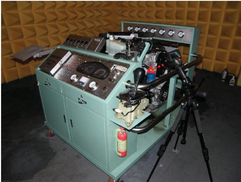
Figura 2. 16 Ubicación de la cámara termográfica.
