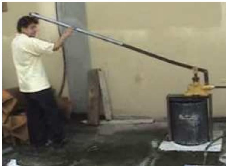
Foto 12: Realización de la Prueba Hidrostática Laboratorio de Fluidos EPN (Patio)
