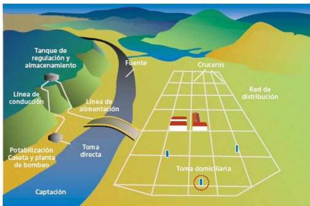
Figura 3.1: Sistema típico de abastecimiento de agua potable
