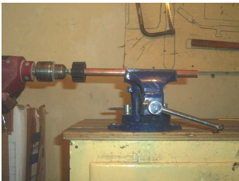
Foto 4: Limpieza del Tubo
