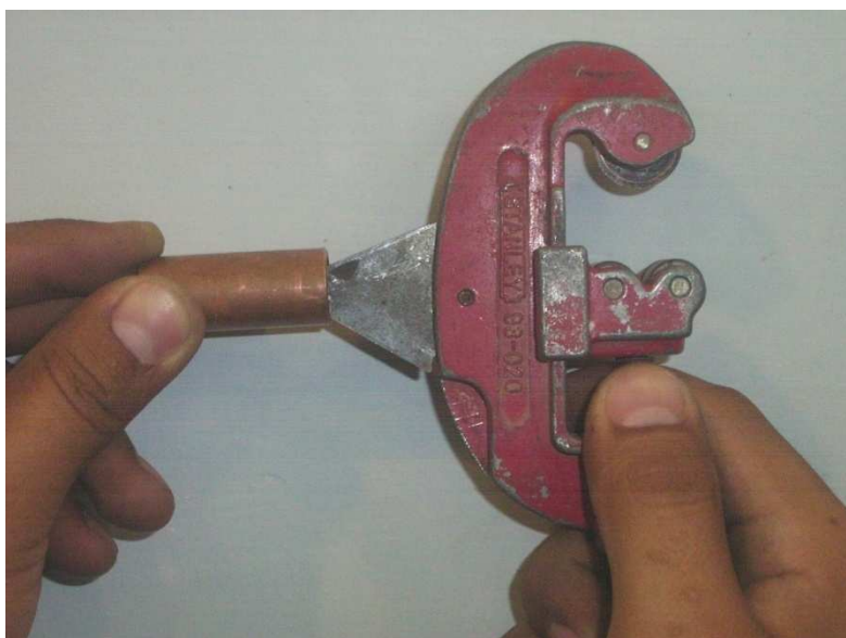
Foto 3: Escariado del tubo para preparación de la probeta
