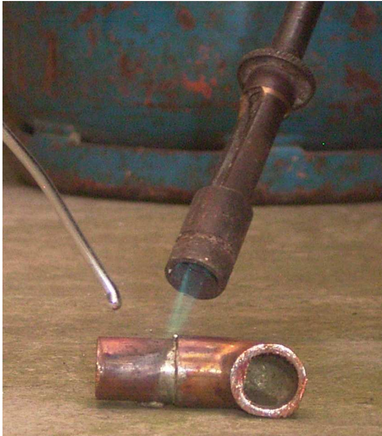
Foto 9: Soldadura de la Probeta con Metal de Aporte Estaño-Antimonio (95-5)
