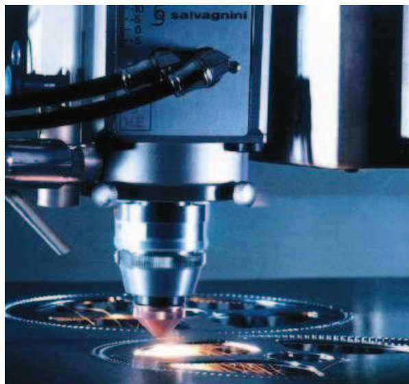
Figura 1.7 Proceso de corte con rayo láser.
