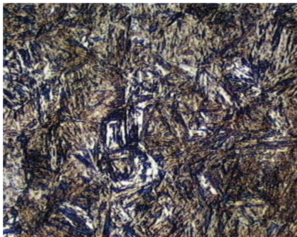
Figura 3.7 Estructura Martensita x400
