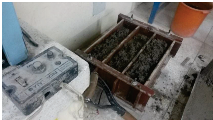
FOTOGRAFÍA 5. 5 ELABORACIÓN DE VIGAS.
