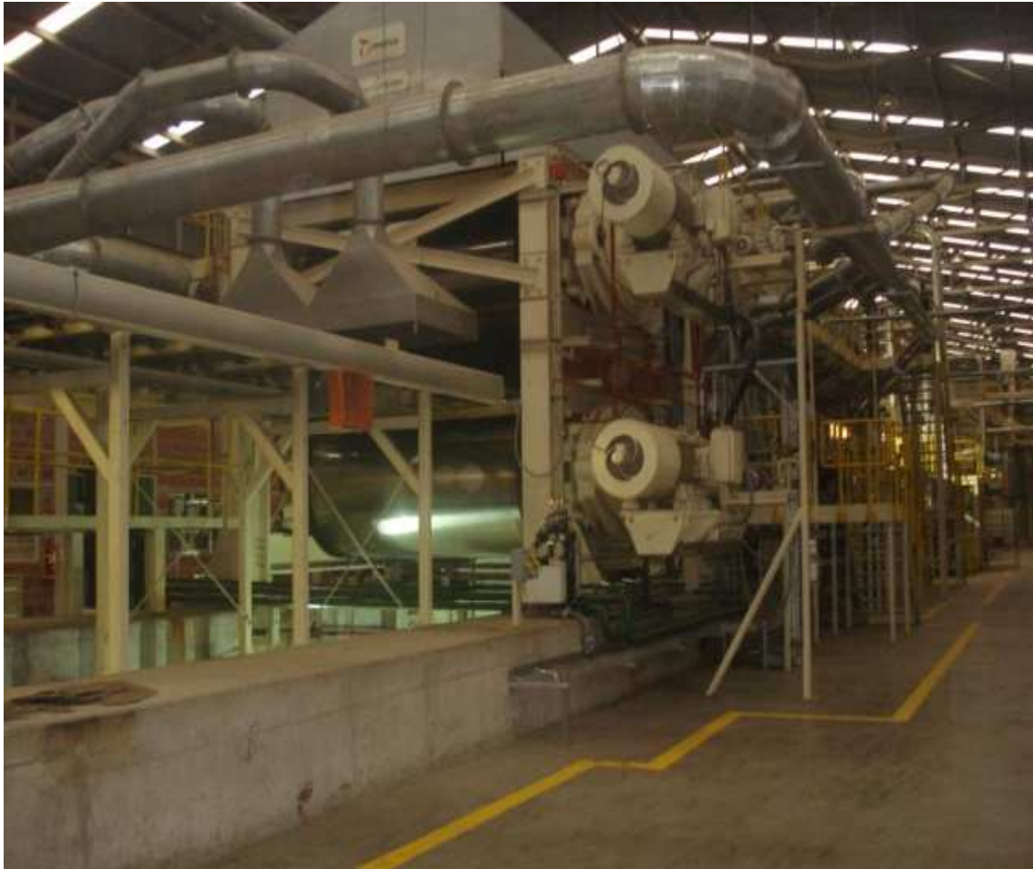
Figura 3.11. Prensa continua contipress
