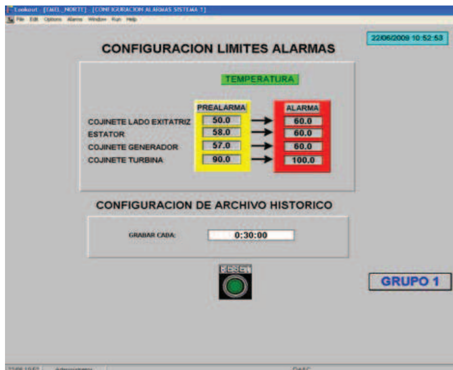
FIG. 2.6 Configuración de los límites de alarmas del interfaz hombre – máquina para el grupo generador 1 de la Central El Ambi.
