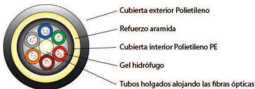
FIG 2.9 Cable de fibra óptica tipo ADSS ( loose tube 1 ). [29]
