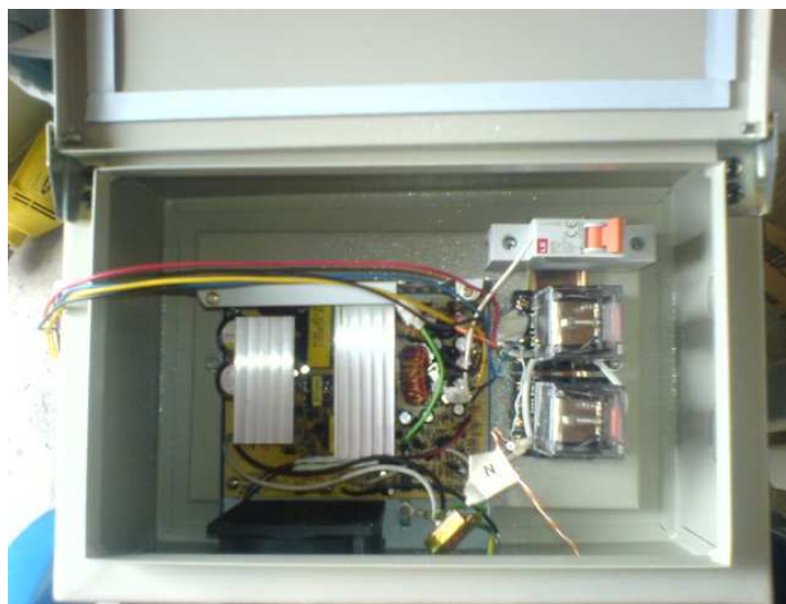
Gráfico 3.14 MONTAJE DE LA FUENTE DE ALIMENTACIÓN Y RELÉS DE 120V
