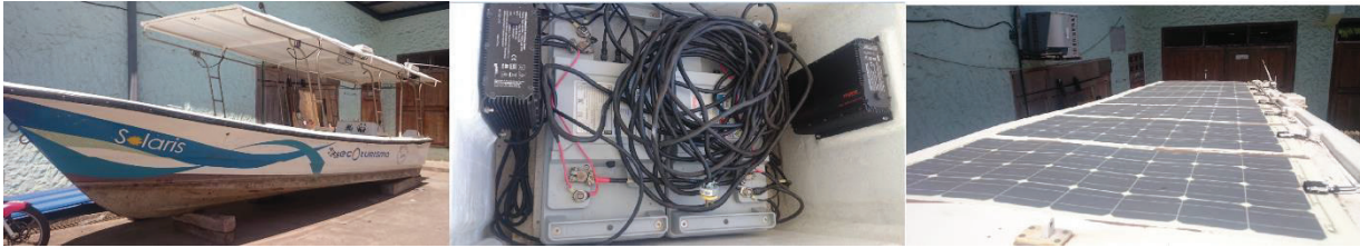
Figura 9. Embarcación SOLARIS con paneles solares y baterías, Puerto Ayora
