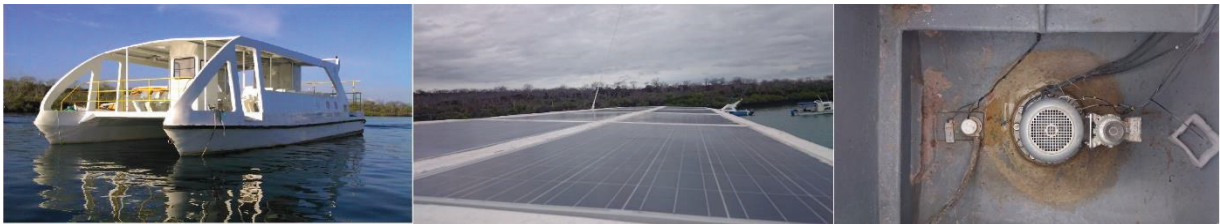
Figura 10. Génesis solar con paneles solares y 2 motores de 10 kW
