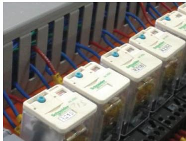
**Figura 2.13** Relés auxiliares de mando de 24 VDC
