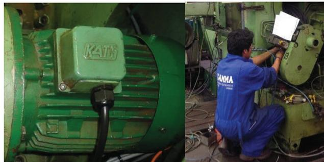
**Figura 3.11** Motor y su respectiva caja de bornes
