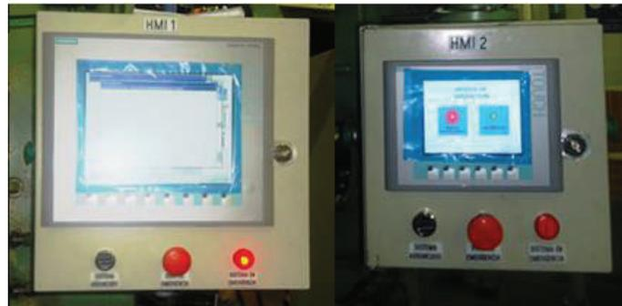
**Figura 2.20** Paneles de mando HMI 1 y 2
