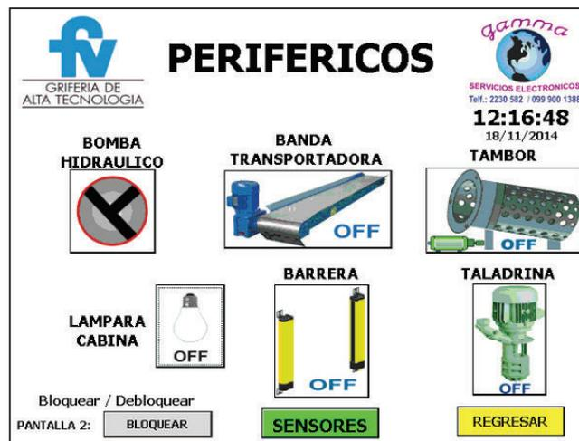
**Figura 3.22** Pantalla de activación de periféricos
