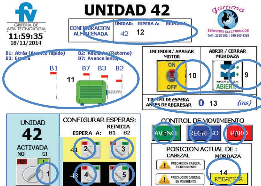
Fig15. Elementos de la pantalla de configuración de la unidad 42
