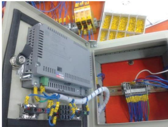
**Figura 2.32** Implementación de paneles de mando HMI
