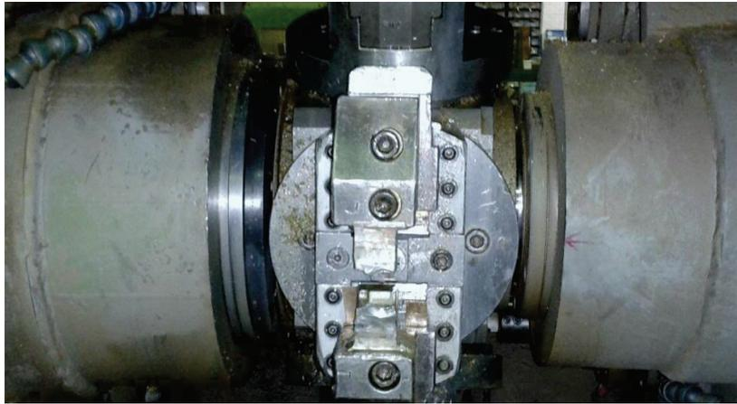
**Figura 1.10** Cabezal tipo revolver
