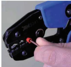
**Figura 2.33** Ponchado de terminales tipo horquilla
