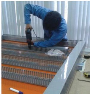
**Figura 2.25** Perforación sobre la superficie de sujeción
