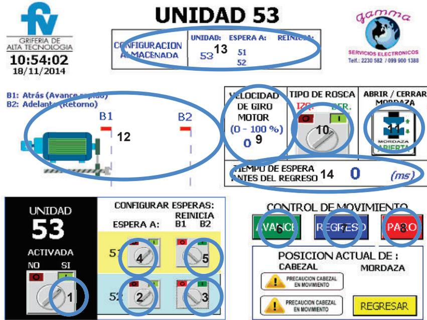
Fig7. Elementos de la pantalla de configuración de la Unidad 53
