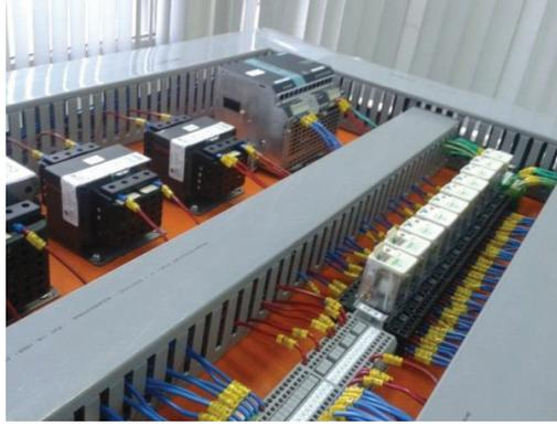
**Figura 2.39** Cableado de control de relés de mando
