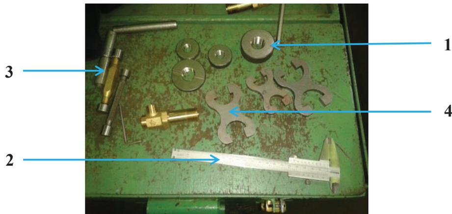
**Figura 1.24** Instrumentos de verificación “calibres” para la pieza
