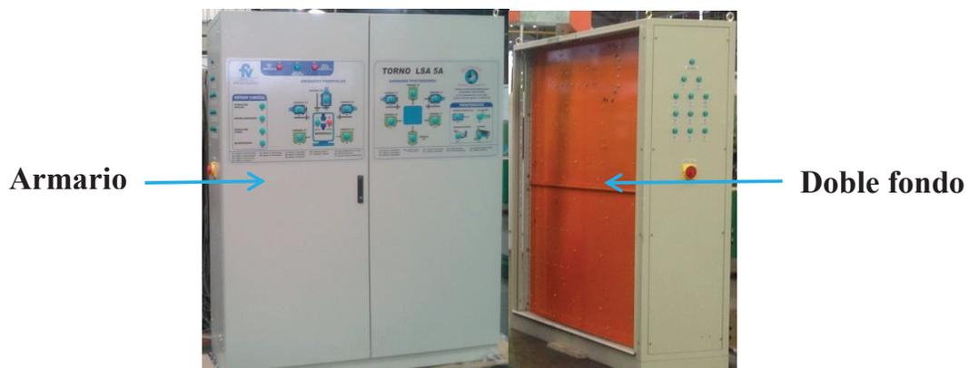
**Figura 2.1** Vista frontal y posterior del tablero
