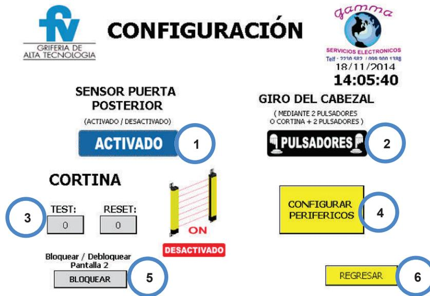
Fig9. Elementos de la pantalla de configuración de sensores
