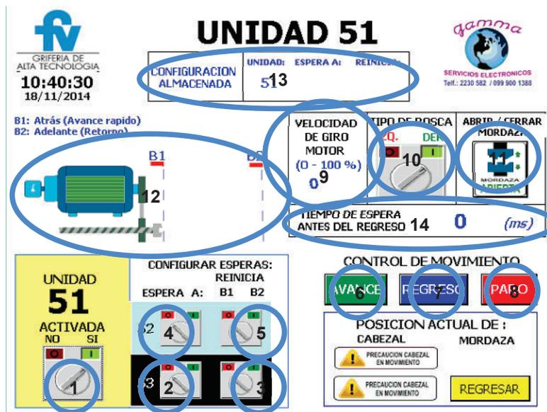
Fig5. Elementos de la pantalla de configuración de la Unidad 51
