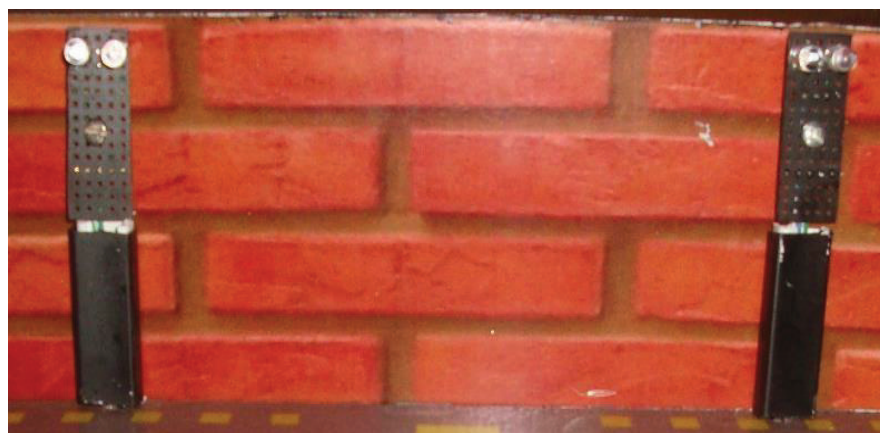
Figura 3. Leds, rojo y verde, en baquelita perforada.
