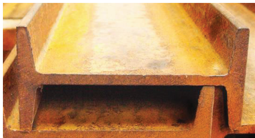
FIGURA 2.1 PERFILES ESTÁNDAR LAMINADOS EN CALIENTE.
