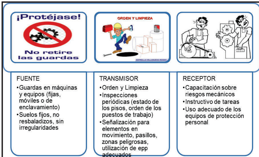
Figura 32 - Control Riesgos Mecánicos
