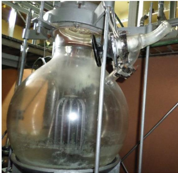
**Figura 1.9.** Válvula de ingreso (V1) y depósito de mezcla (Dep 1)
