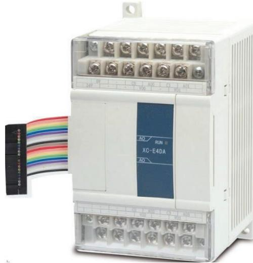
**Figura 2.5.** Módulo de analógico de expansión [5]
