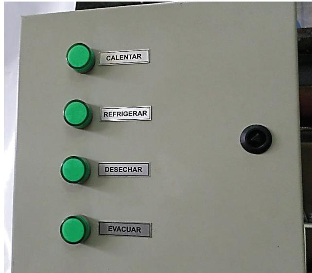
**Figura 2.33.** Vista externa del tablero de potencia
