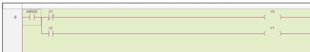
**Figura 3.28.** Señal digital del sensor nivel del calderín
