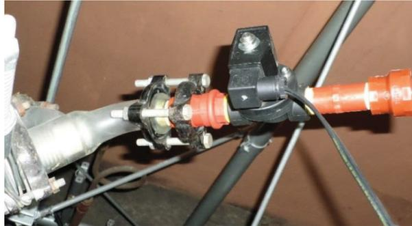
**Figura 2.47.** Montaje de la electroválvula en el ingreso de la mezcla
