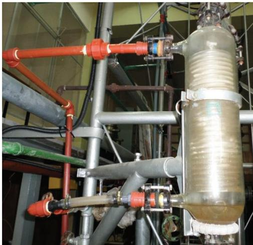
**Figura 2.50.** Depósito de calentamiento
