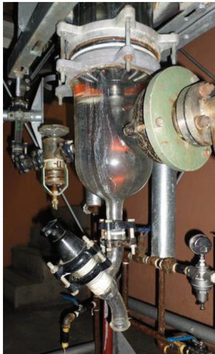
**Figura 1.12.** Válvula de desfogue de residuos (V11)
