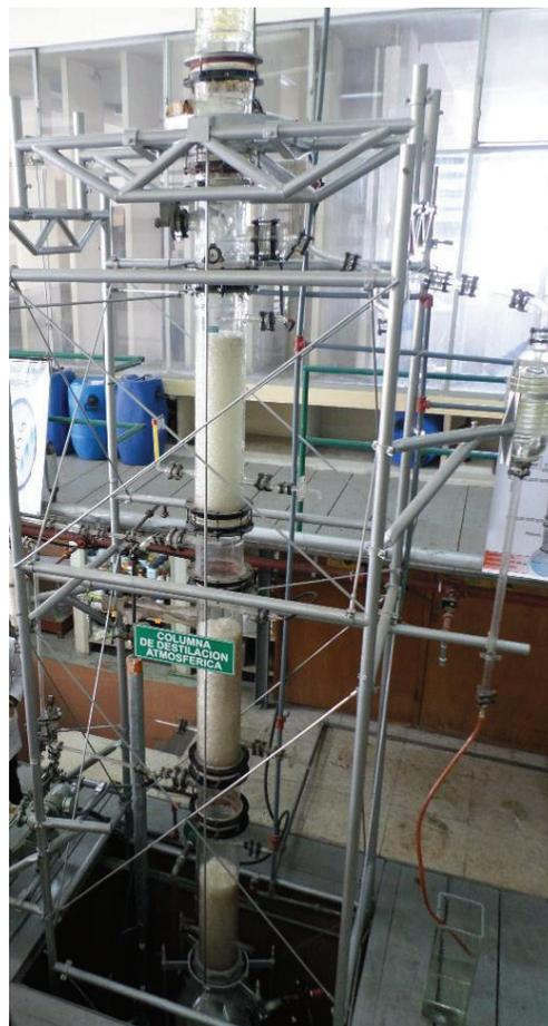
**Figura 1.5.** Columna de destilación atmosférica del laboratorio de procesos unitarios
