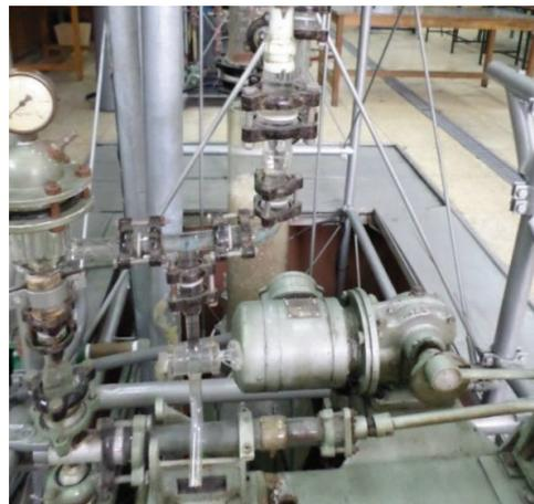
**Figura 2.13.** Bomba trifásica de desplazamiento positivo presente en el laboratorio
