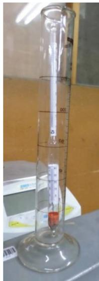
**Figura 4.9.** Alcoholímetro (comprobación manual)
