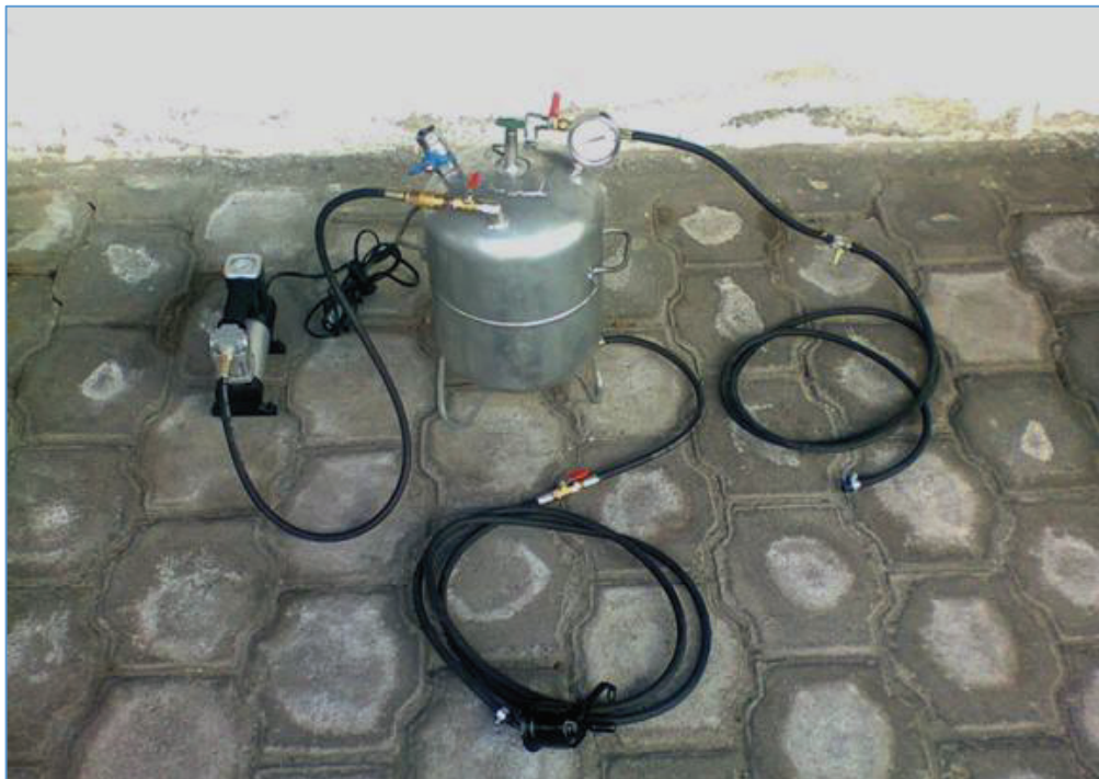
Figura 11. Canister con sus conexiones y compresor.
