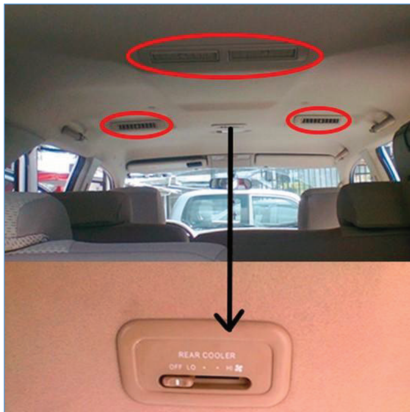
Figura 24. Salidas y control de aire en el techo.
