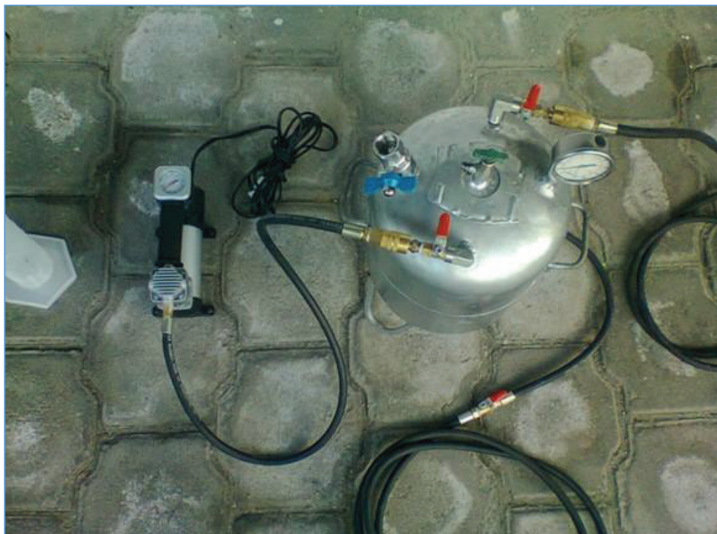
Figura 13. Canister con las válvulas superiores en posición de trabajo.
