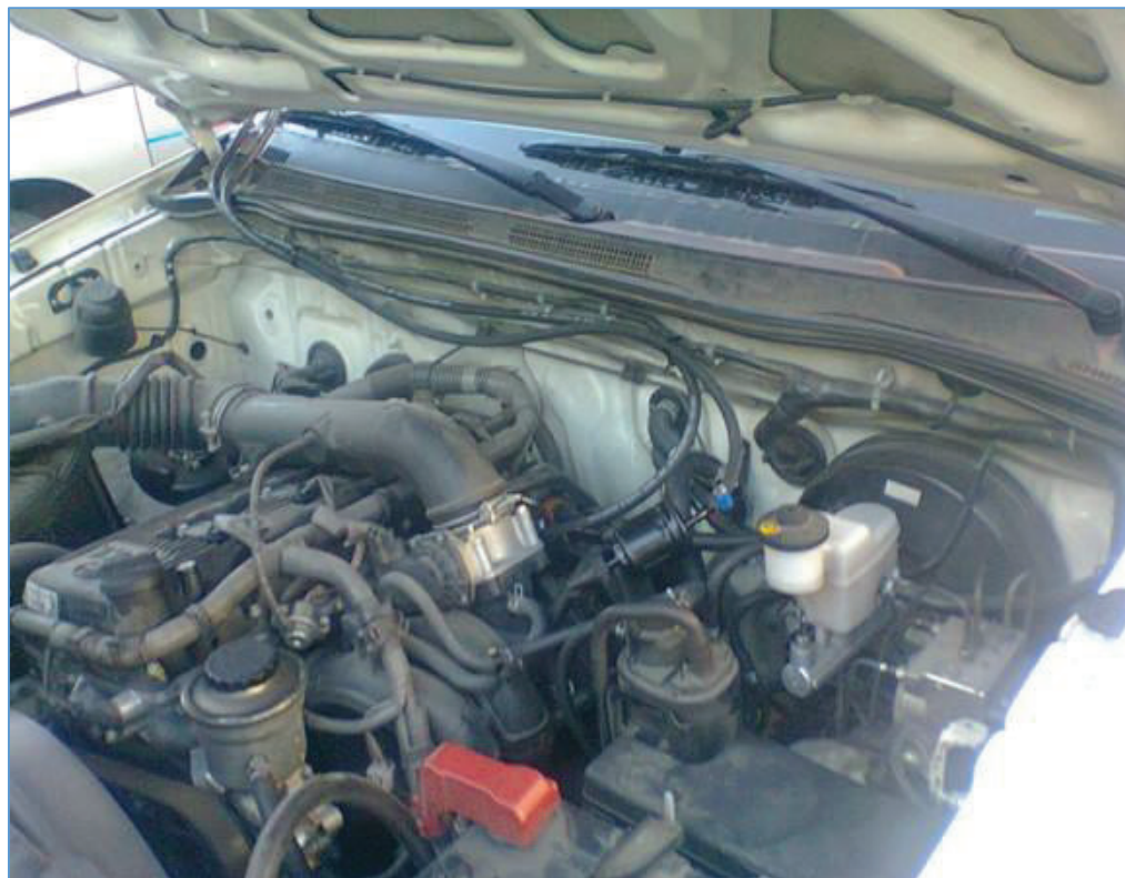
Figura 16. Conexiones del canister en el motor.
