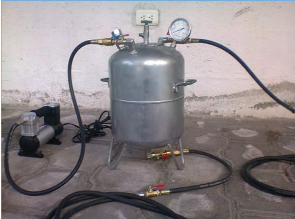
Figura 12. Canister con las válvulas inferiores en posición de trabajo.
