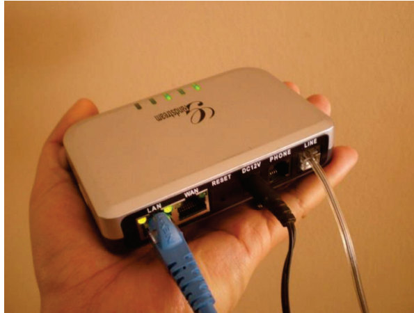
Figura 4.34. Gateway Grandstream HT503 en funcionamiento
