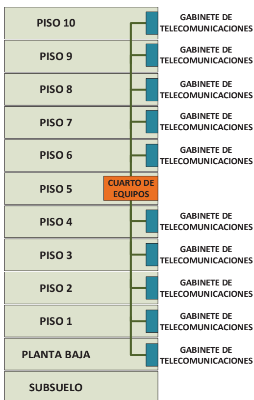
Figura 3.1. Distribución de cuarto de equipos y gabinete de telecomunicaciones en el edificio del MIES
