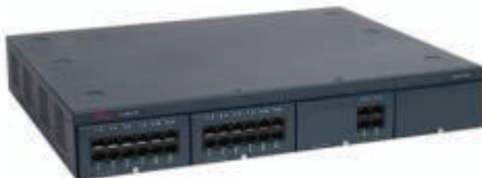
Figura 2.45. Central Telefónica AVAYA IP Office 500 42
