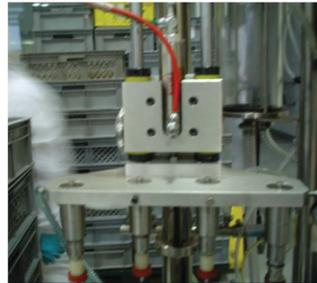
**Figura 3.22.** Pistón con guías para las agujas.
