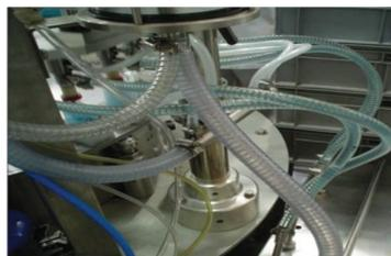
**Figura 3.20.** Manguera con alma Metálica
