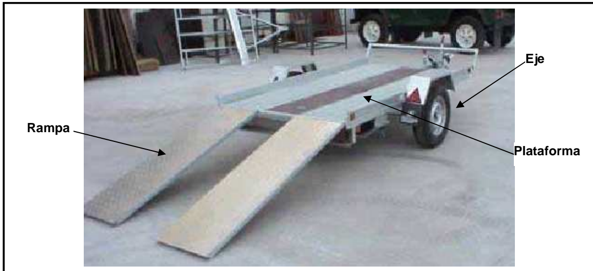
Figura N° 2.6.- Remolque de un eje con plataforma y rampas largas.
