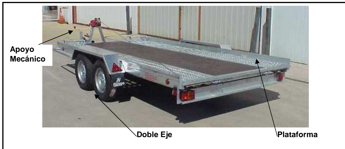
Figura N° 2.8.- Remolque de doble eje con plataforma y apoyo mecánico.
