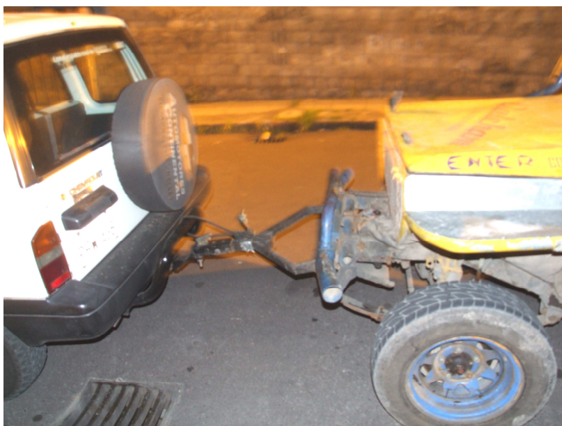
Figura N° 2.3.- Métodos de transporte de vehículos de competencia 4x4 usando un gancho de tiro.
