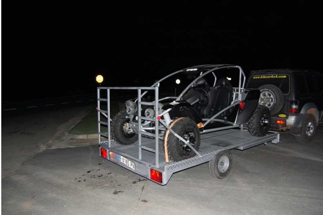
Figura N° 2.5.- Método de transporte de vehículos de competencia 4x4 usando una plataforma remolque.
