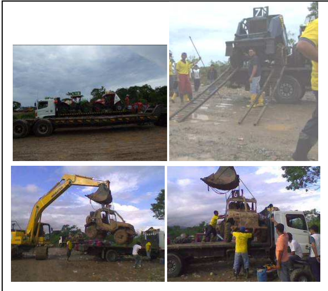
Figura N° 2.4.- Método de transporte de vehículos de competencia 4x4 usando un vehículo de carga.
