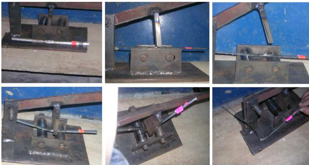
Figura 4. 37 Secuencia del ensayo de doblado
