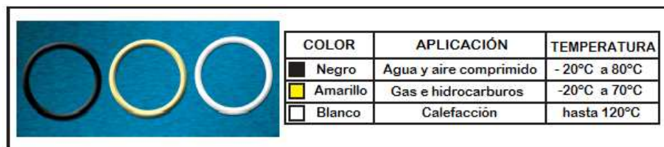
Figura 3.11 Anillos o ring para instalaciones de alta compresión. 19
