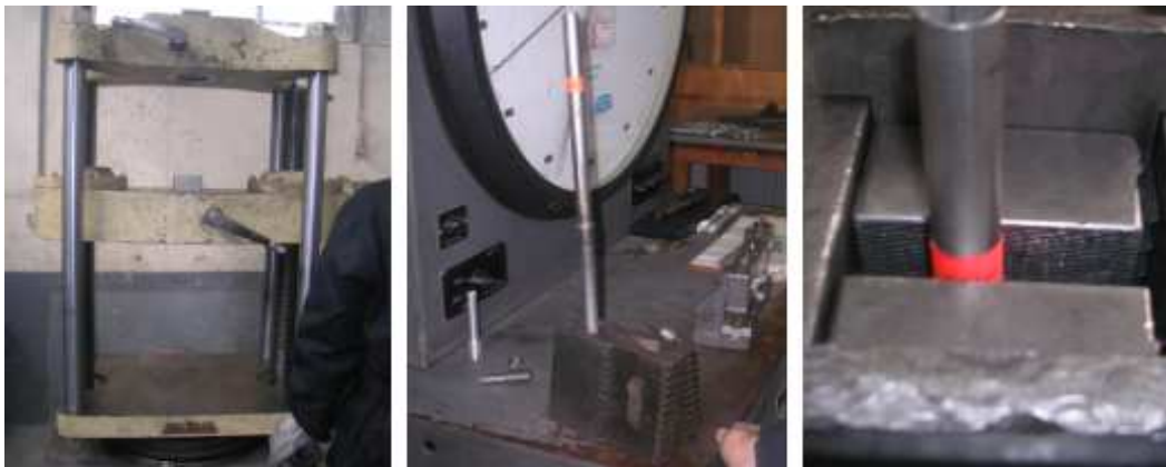
Figura 4. 30 Máquina Universal y sujeción de probetas
