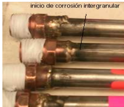
Figura 1. 8 Unión en fuerte de cobre y acero inoxidable 304 con temperatura mayor a 800°C
