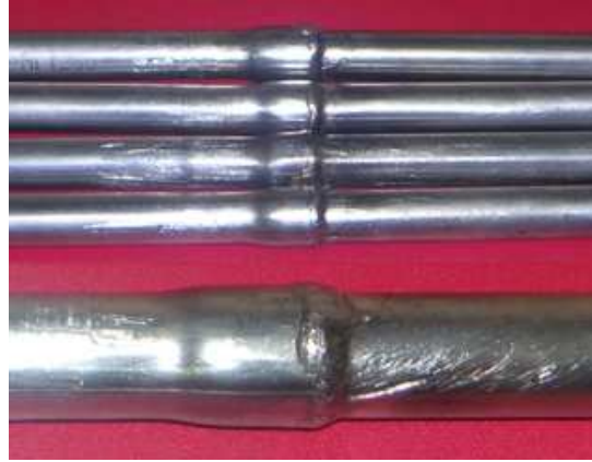
Figura 5. 24 Soldadura Fuerte en Tubos de acero inoxidable AISI 304
