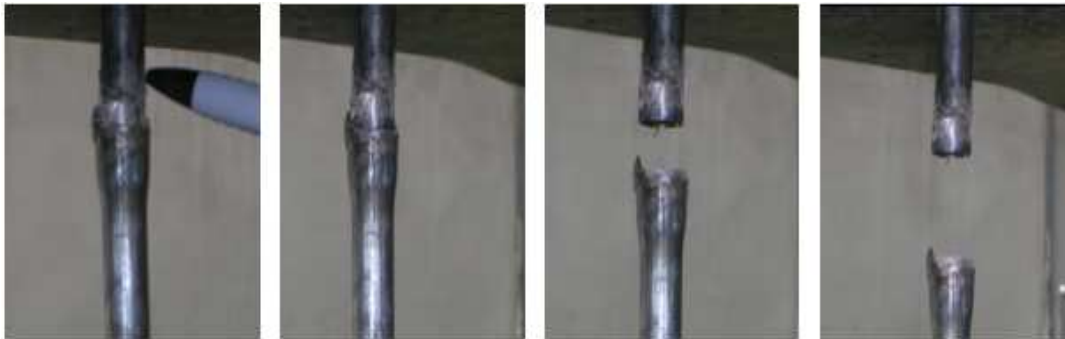
Figura 4. 32 Secuencia del Ensayo de Tracción
