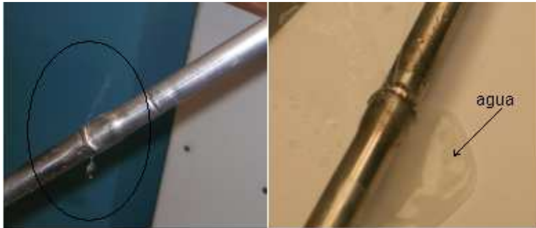
Figura 5. 14 Fugas en probetas ensayadas
