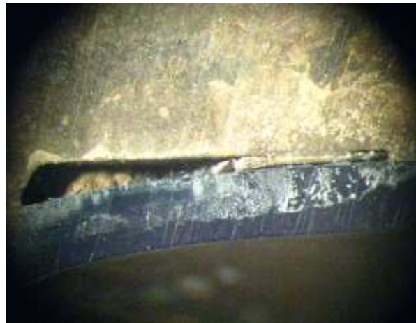
Figura 5. 22 Penetración irregular en probetas BAg-2 (empresa local)
