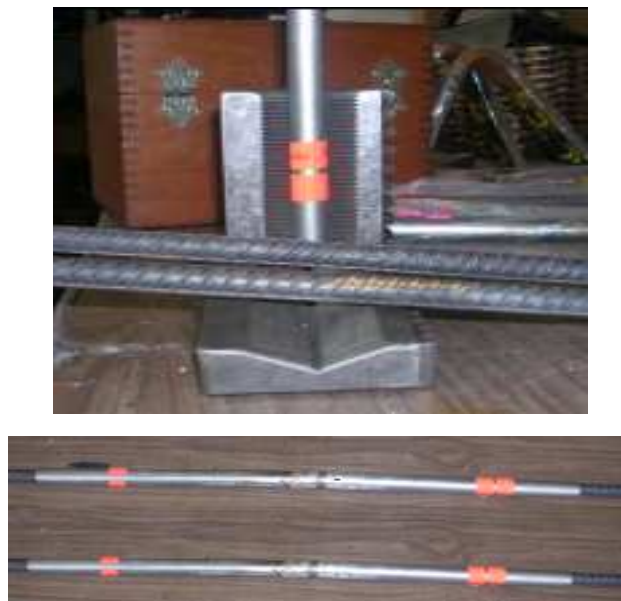
Figura 4. 25 Mordazas de sujeción y varilla corrugada insertada en las probetas
