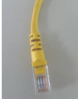
Figura 3.3. Terminación de Cable UTP con conector RJ-45 Macho
