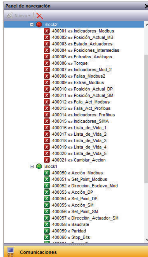
Figura 3.10. Variables del HMI asignadas a cada registro.
