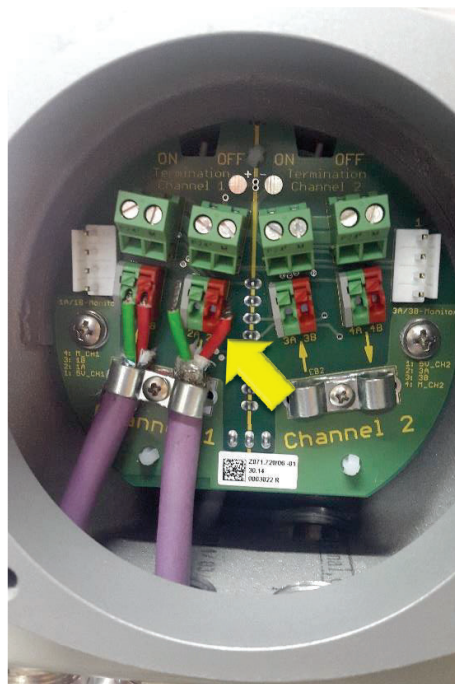
Figura 4.3. Ruptura del lazo de comunicación
