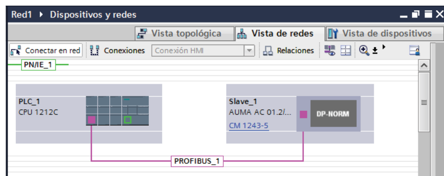
Figura 2.21. Conexión entre Maestro y Esclavo
